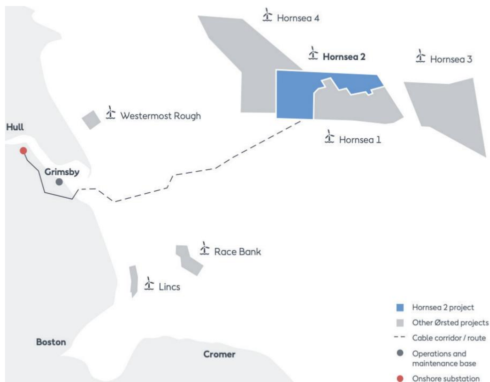
Slika 8.2. Shema priključenja Hornsea Project Two [27]
