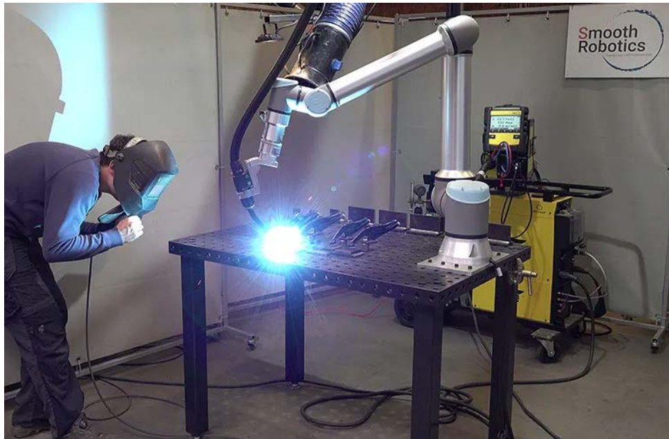
Slika 2.11. Zavarivanje pomoću kobota [15]
