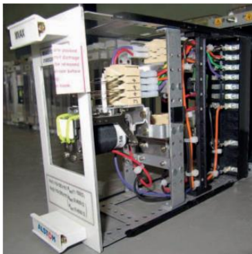
Slika 4.2. Elektromehanički relej u pogonu[12]
