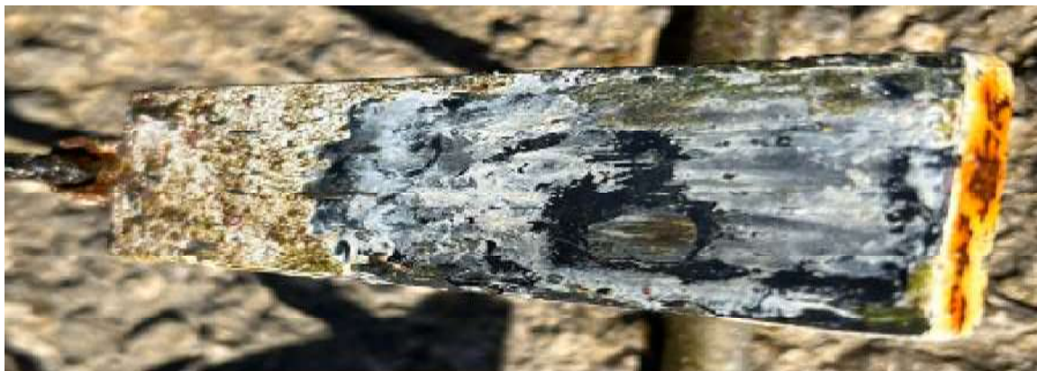
Slika 5.19 Uzorak zaštićen međupremazom i završnim premazom
