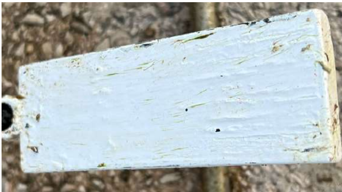
Slika 5.7 Uzorak zaštićen međupremazom i završnim premazom
