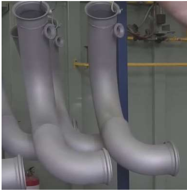
Slika 4.17 Cijevi nakon nanošenja keramičke prevlake [21]
