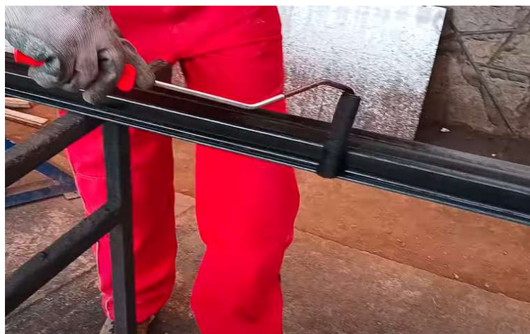
Slika 4.27 Nanošenje boje valjkom [24]
