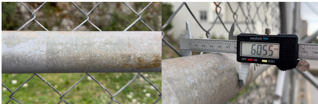
Slika 4.3 Mjerena poprečna cijev ograde javnog sportskog igrališta
