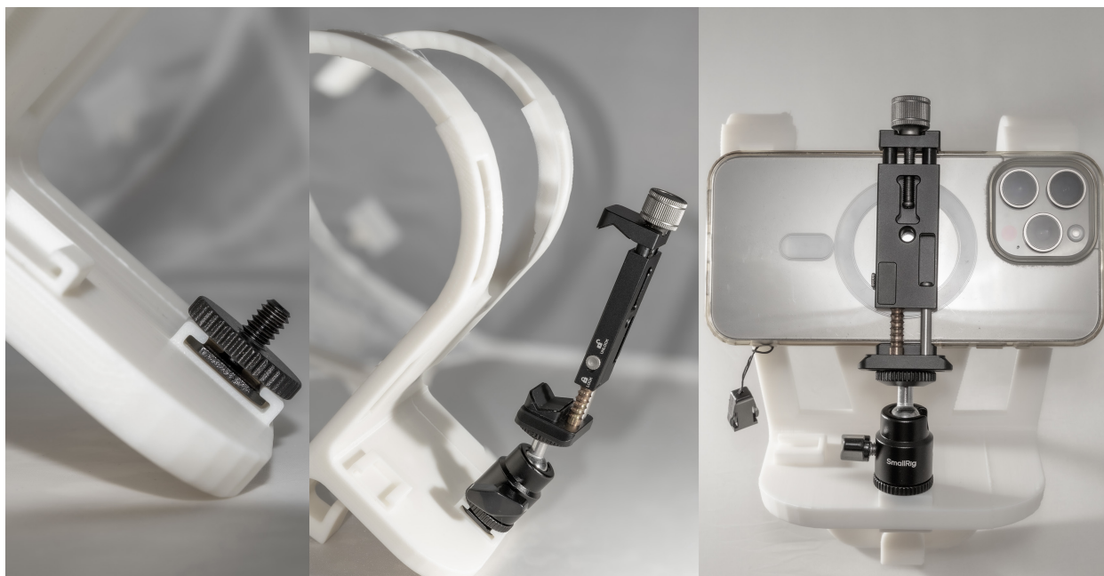
Slika 7.2 Koraci montiranja pametnog telefona na nosač
