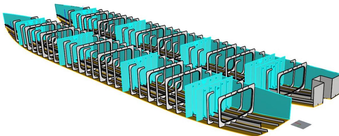
Slika 6.1.6.2. Izometrijski prikaz uzdužnih elemenata trupa [27]
