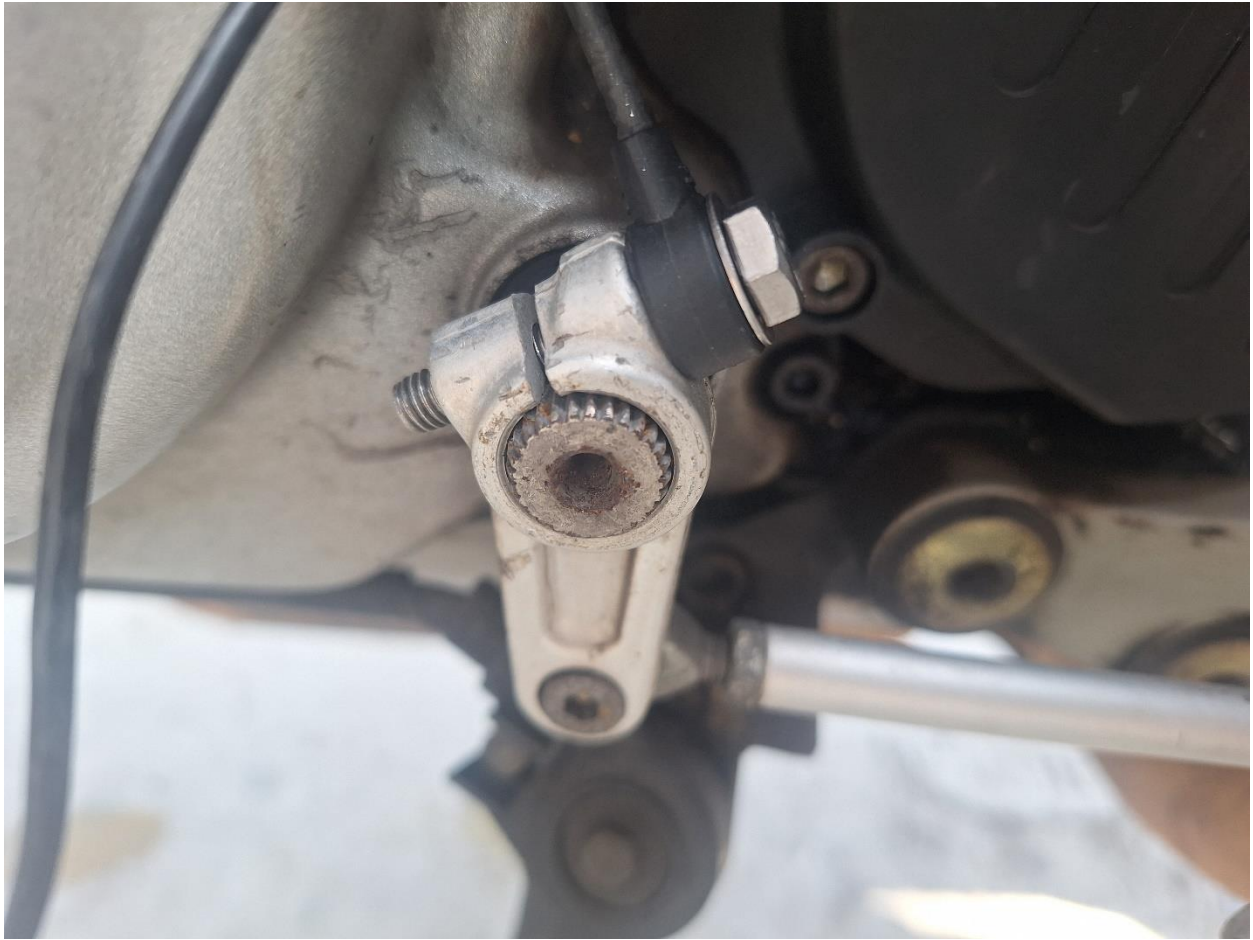
Slika 7.1 Senzor poluge mjenjača za promjenu stupnja prijenosa
