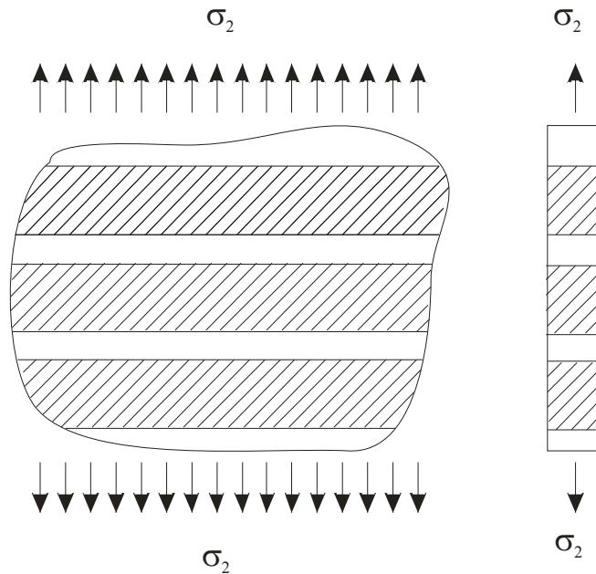
Slika 4.7. Jednostavniji oblik poprečno opterećenog jednosmjernog kompozita.
