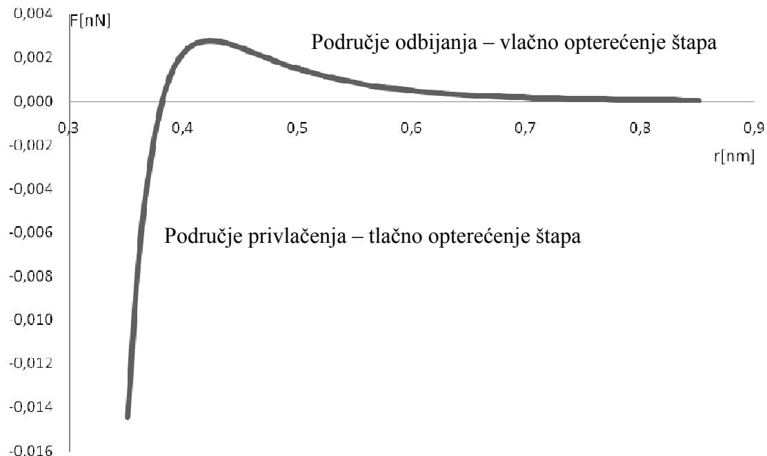
Slika 5.2. Krivulja opterećenje – pomak za nelinearni štapni element.
