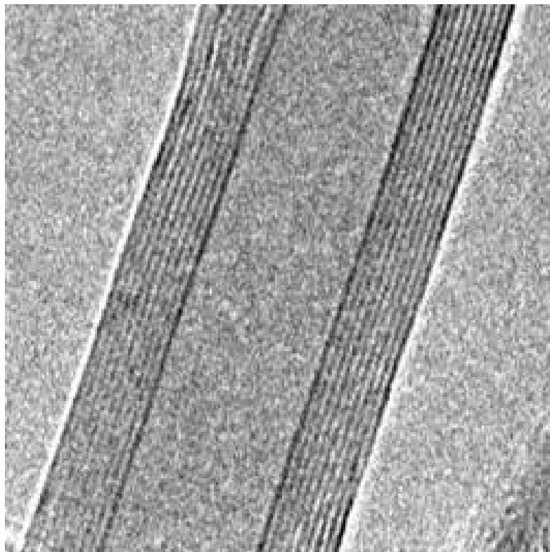
Slika 5.4. TEM snimak deveterostrukih ugljičnih nanocijevi [81].
