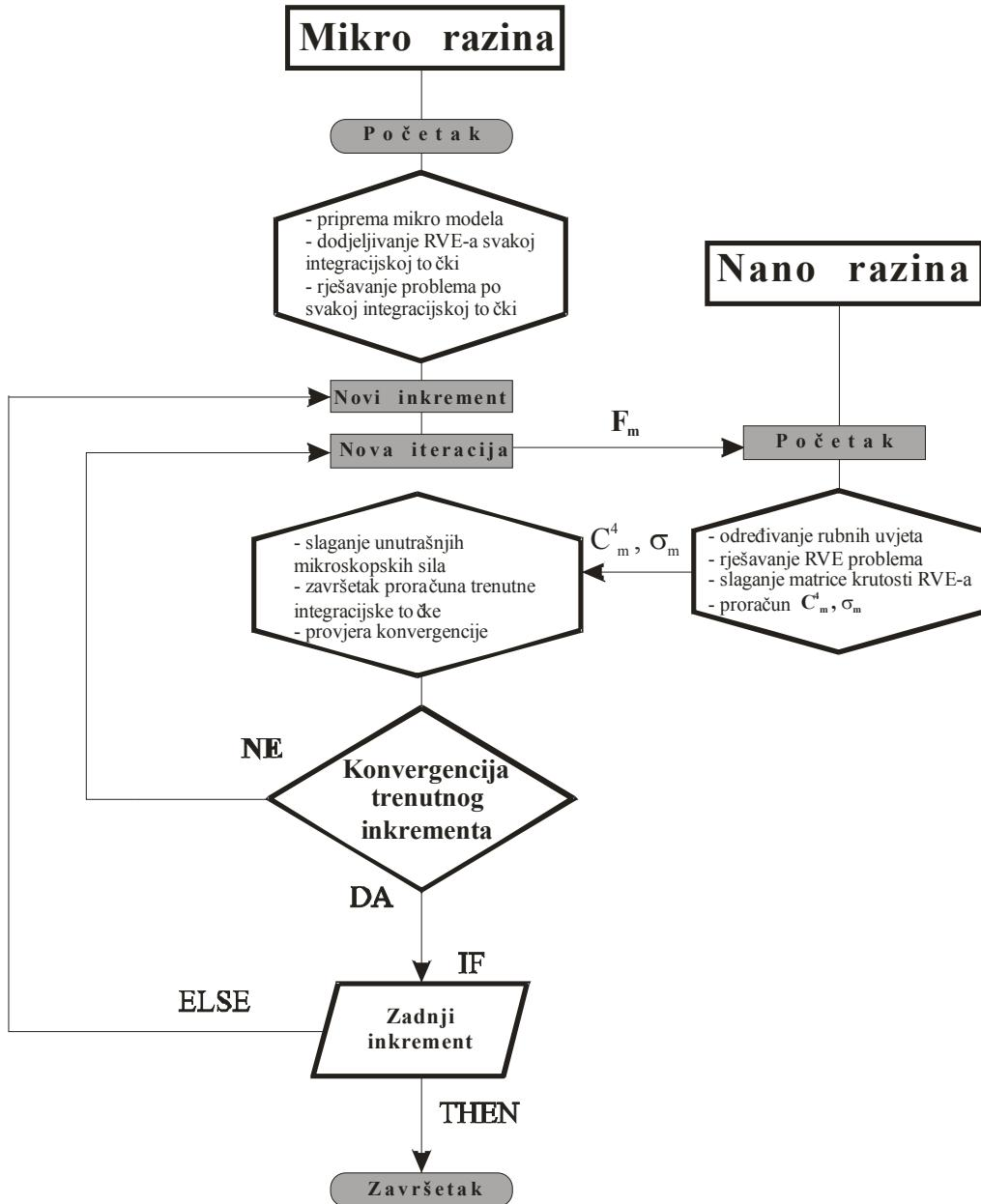
Slika 6.5. Shematski prikaz osnovnih koraka dvorazinske računalne homogenizacije.
