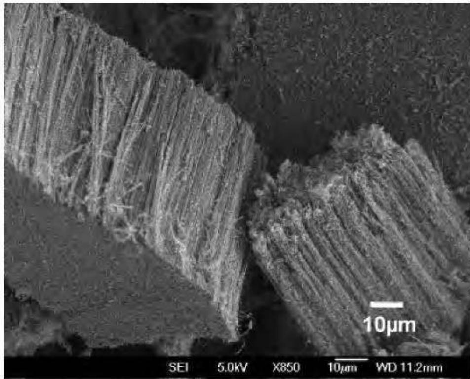
Slika 4.14. SEM mikroografski snimak snopova višestrukih ugljičnih nanocijevi, proizvedenih kemijskim taloženjem [68].
