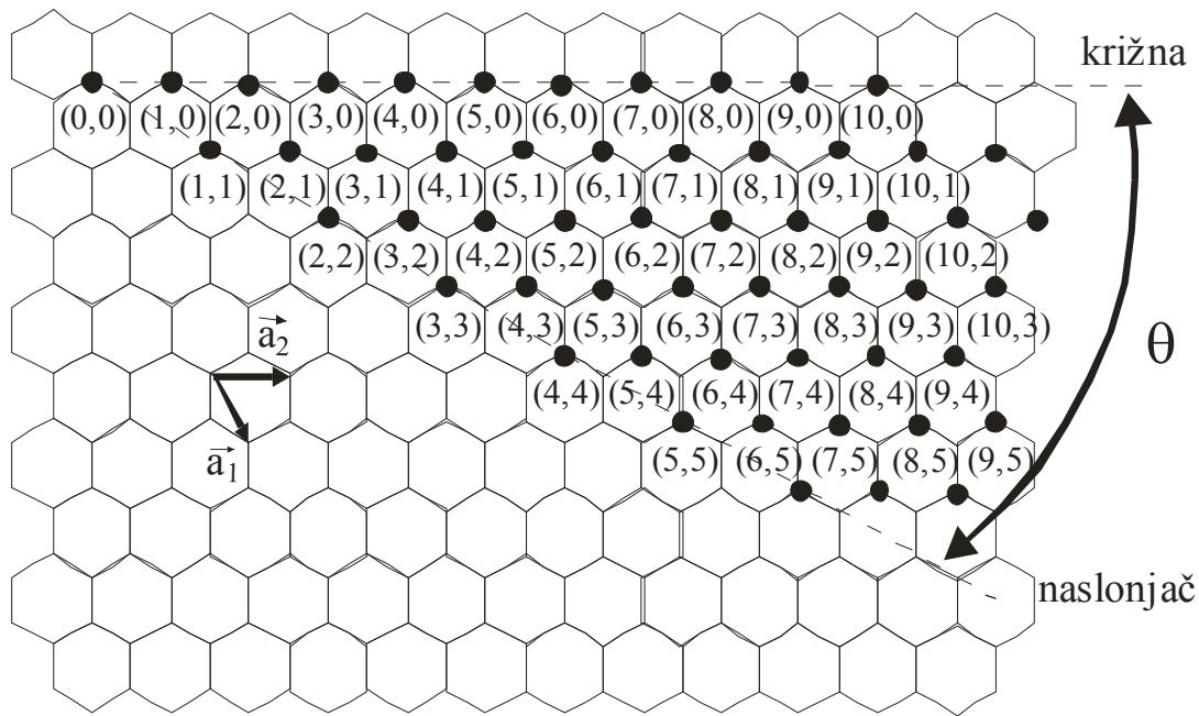
Slika 3.6. Shematski prikaz određivanja vrste nanocijevi [59].
