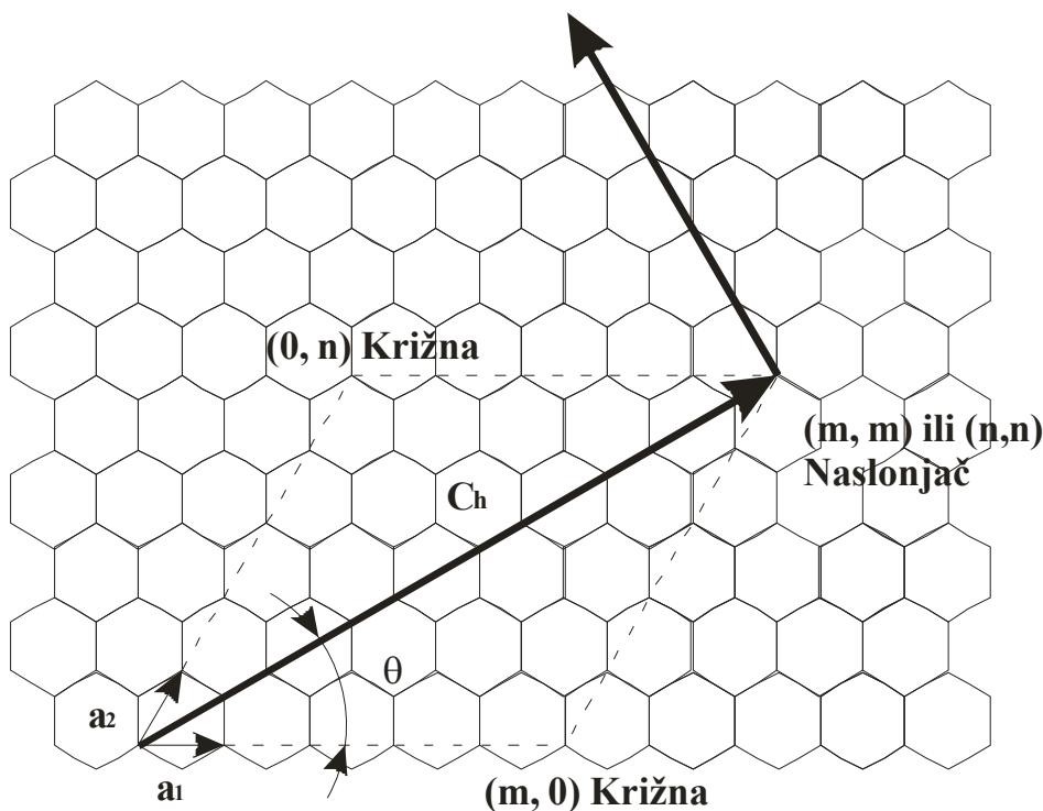
Slika 3.4. Vektor zakrivljenosti u sastavu nanocijevi.
