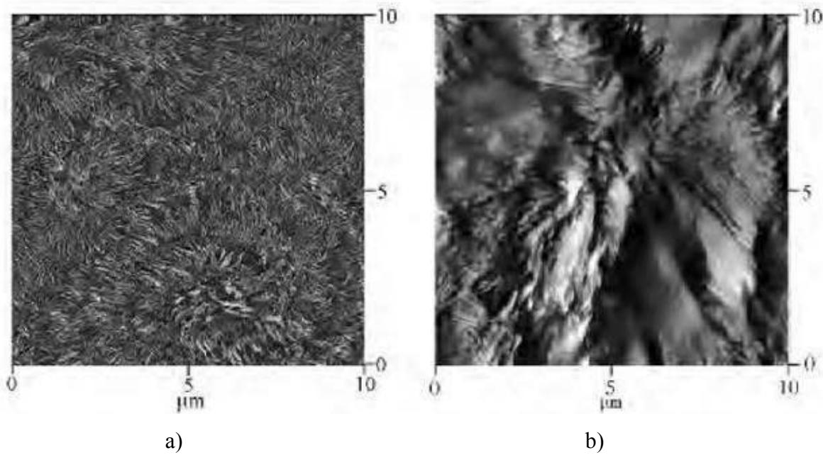
Slika 4.12. AFM mikroografski snimak koji prikazuje promjenu u kristalizaciji za: a) polietilen niske gustoće, b) polietilen niske gustoće s 5% volumnog udjela titanijum dioksid nanočestica [68].
