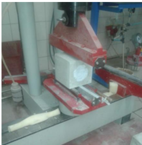
Slika 26 Ispitivanje vlačne čvrstoće betonskih kocki u laboratoriju
