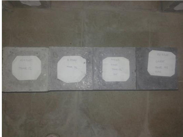
Slika 33 Bojanje betonskih uzoraka ovisno o postotku zamjene
