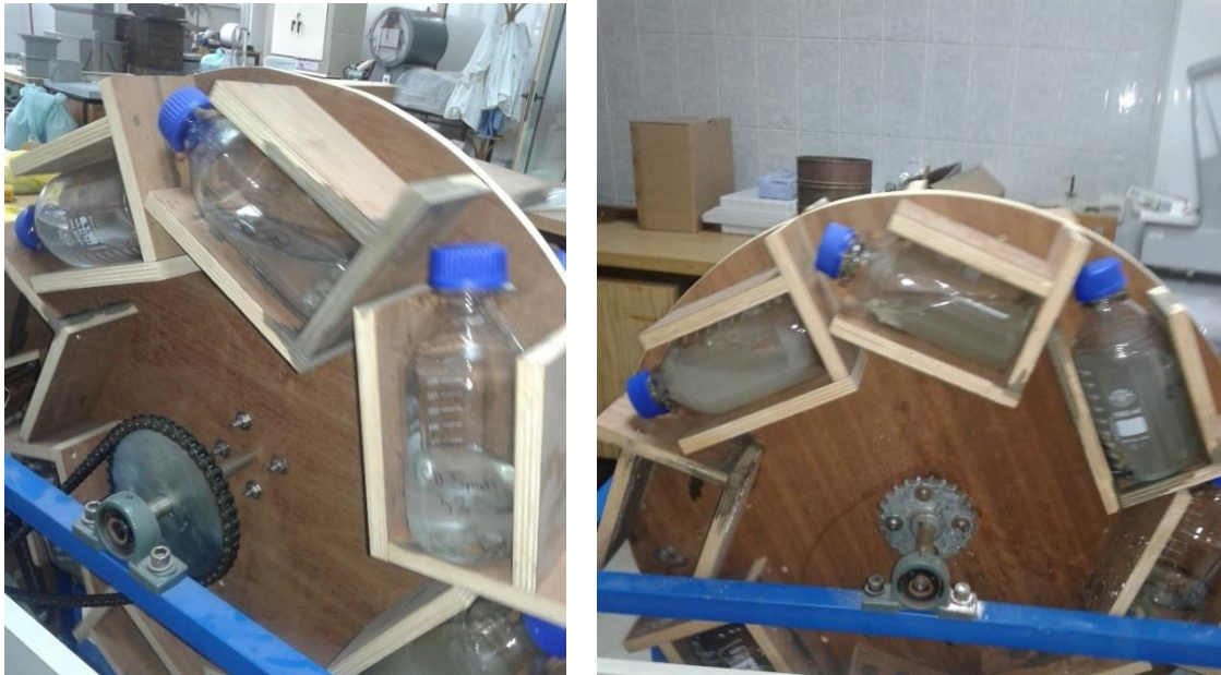
Slika 15 Izvođenje testa izluživanja u Laboratoriju za inženjerstvo okoliša
