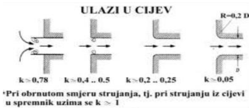
Slika 3.7. Koeficijent K kod ulaza u cijevi
