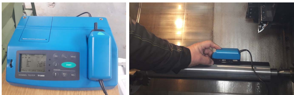
Slika 5.11. Profilometar Hommel Tester T1000 i mjerenje hrapavosti obrađene površine
