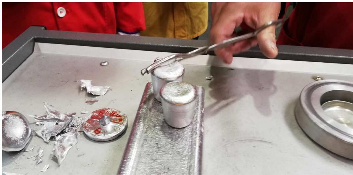
Slika 6.28: Tri uzorka magnezijem dolegirane AlSi9Cu3(Fe) legure za kontrolu kvalitete, od čega dva uzorka za vakuum test i jedan uzorak za ispitivanje kemijskog sastava optičkim emisijskim spektrometrom
