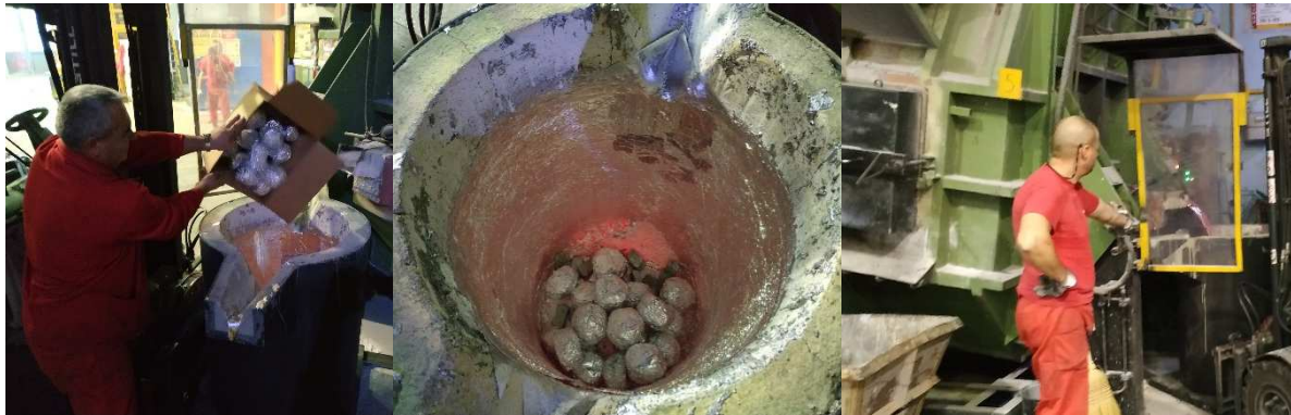
Slika 6.25: Dodavanje magnezija i MWCNT u lonac te dodavanje taljevine Al-legure
