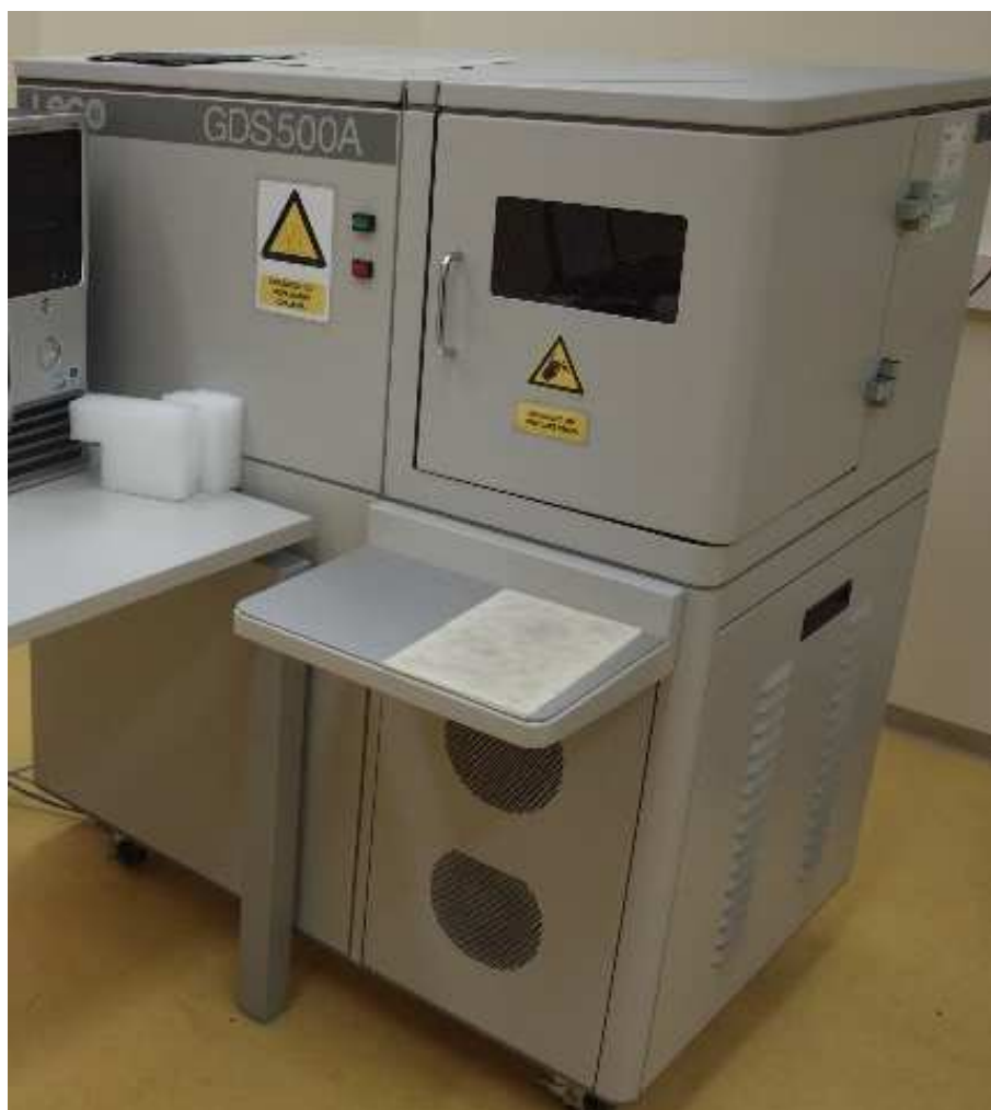
Slika 6.1: Oprema METRIS-a za kemijske analize: optički emisijski spektrometar Leco GDS 500A
