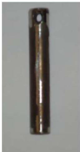
Slika 4.11. Oljuštena Ni-P prevlaka nakon toplinske obrade.
