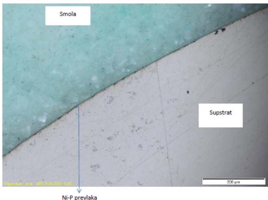
Slika 4.81. Ni-P prevlaka i supstrat toplinski obrađenog uzorka na 300 °C
