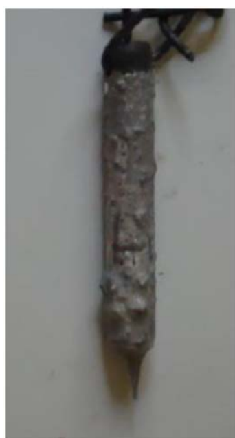
Slika 4.14. Aluminizirani uzorak X5CrNiMo17-12-2
