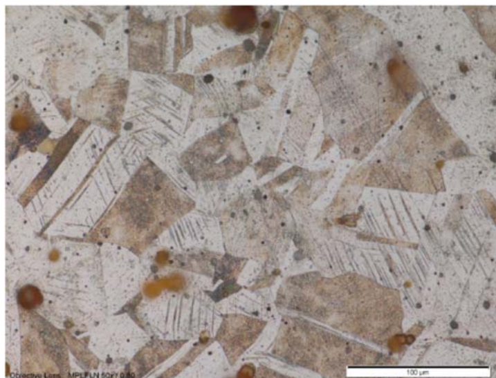
Slika 4.7. Mikrostruktura supstrata X5CrNiMo17-12-2
