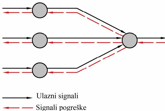
Slika 5.5 Tok ulaznih signala i signala pogreške u višeslojnem perceptronu, prema [28]
