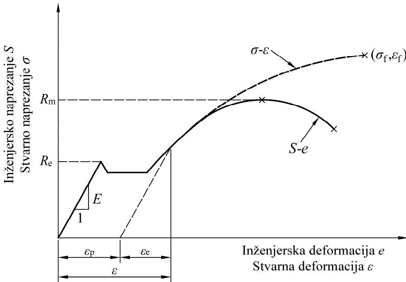
Slika 2.1 Dijagram ovisnosti naprezanja i deformacije  $\sigma$ - $e$  dobivenih monotonim vlačnim eksperimentom, prema [5]
