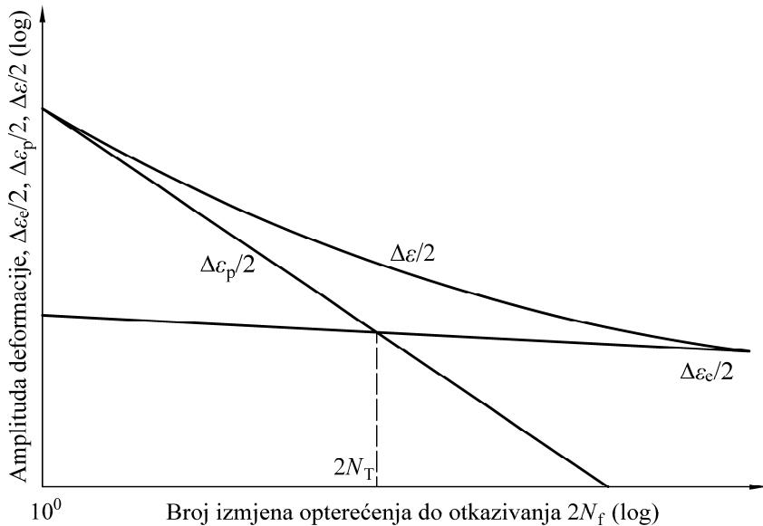
Slika 2.9 Ovisnosti broja izmjena opterećenja do otkazivanja  $2N_f$  o amplitudi elastične  $\Delta\varepsilon/2$ , plastične  $\Delta\varepsilon_p/2$  i ukupne  $\Delta\varepsilon/2$  deformacije, prema [5]
