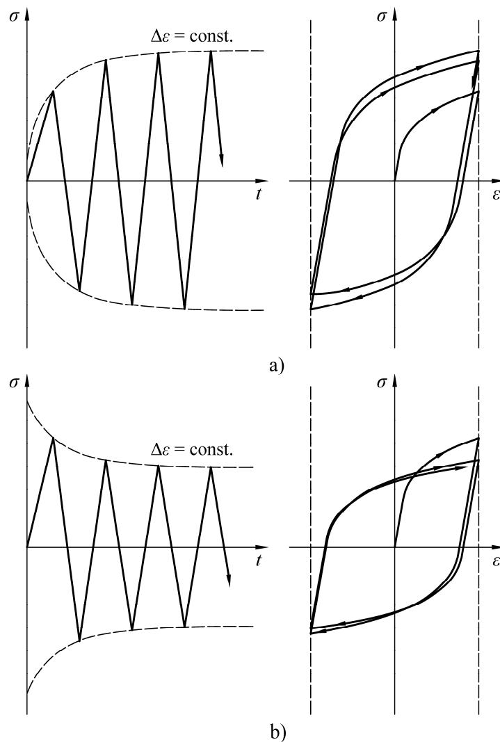
Slika 2.3 Ponašanje materijala pod djelovanjem cikličkog opterećenja u eksperimentima s konstantnom amplitudom deformacije  $\Delta\epsilon/2$ : a) cikličko očvršćivanje, b) cikličko oslabljivanje, prema [41]
