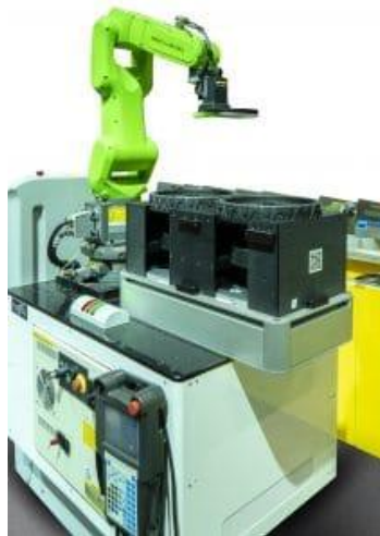
Slika 4.6 Primjer automatiziranog robota za manipulaciju paletnih sustava [ https://clearpathrobotics.com ]
