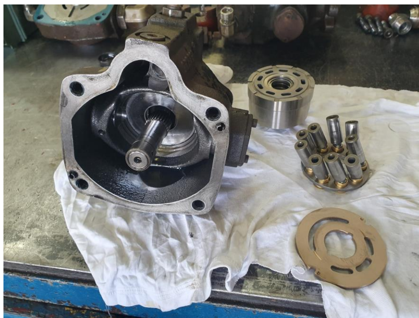
Slika 4-2 Prikaz rastavljene pumpe i njenih sastavnih dijelova
