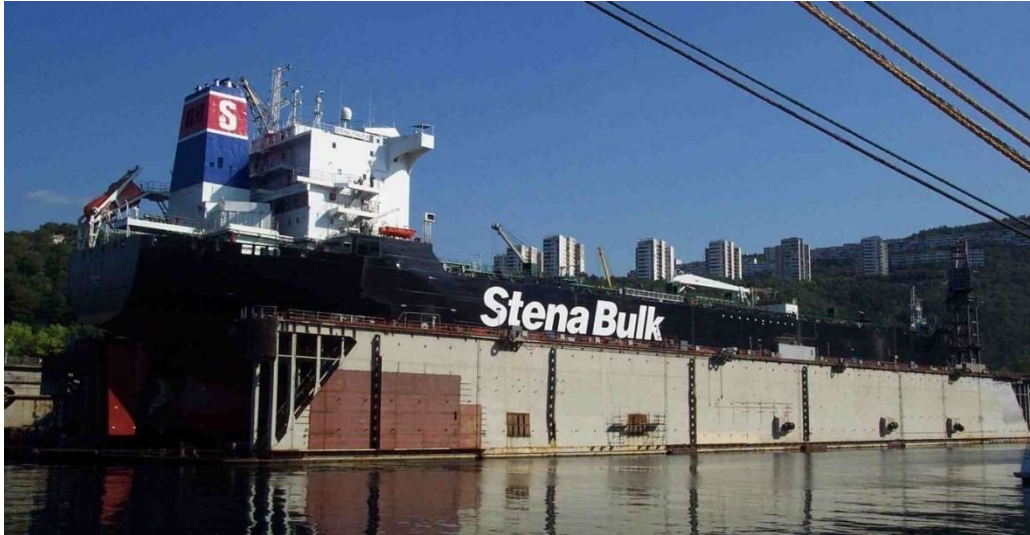
Slika 2-5. Brod u plutajućem doku, pogled na krmu. Izvor: autor
