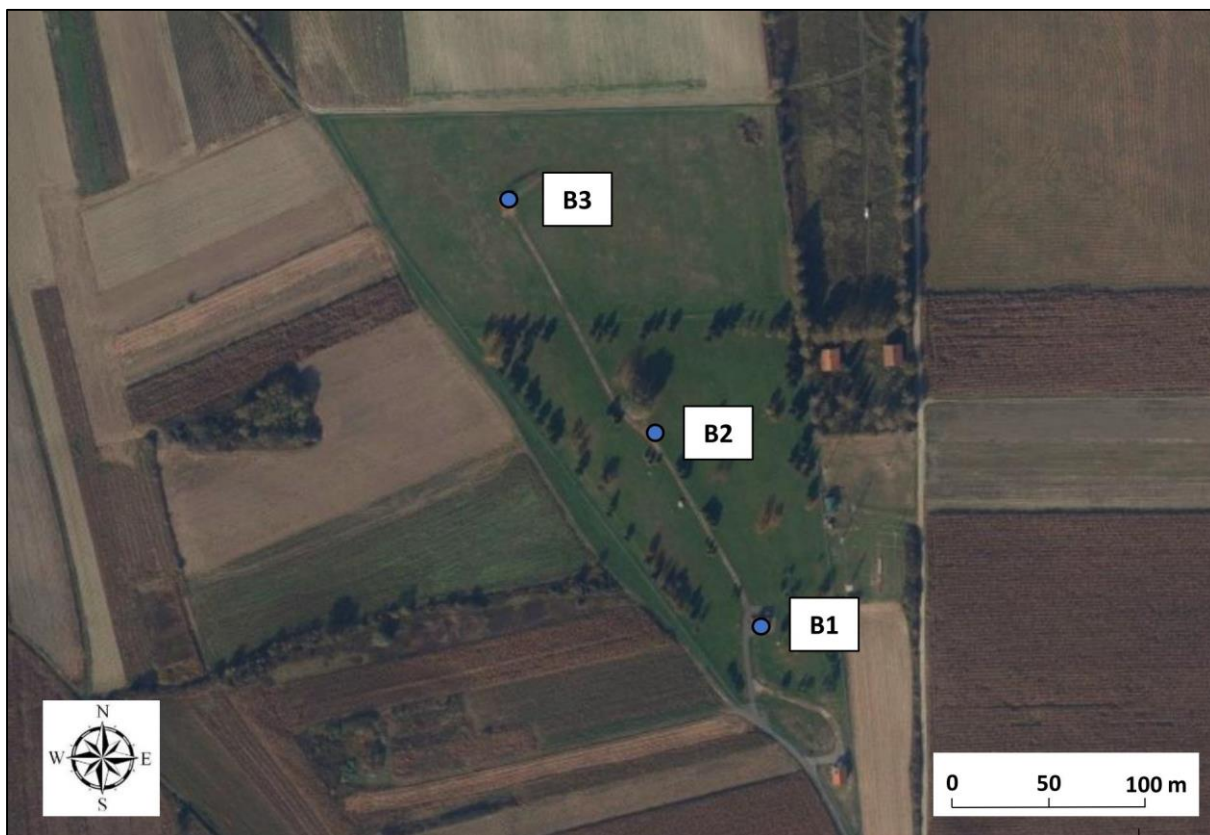
Slika 5-12 Prostorni raspored bunara na vodocrpilištu Vinokovščak
