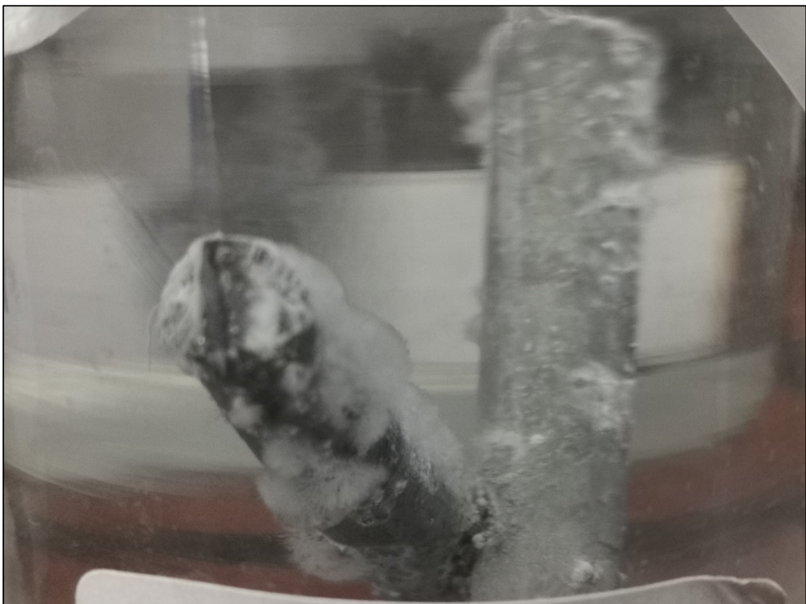
Slika 8.44. Drugi pregled – 15K – veće količine bijele korozije
