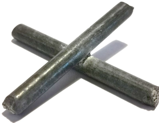
Slika 8.3. Križni zavareni spoj
