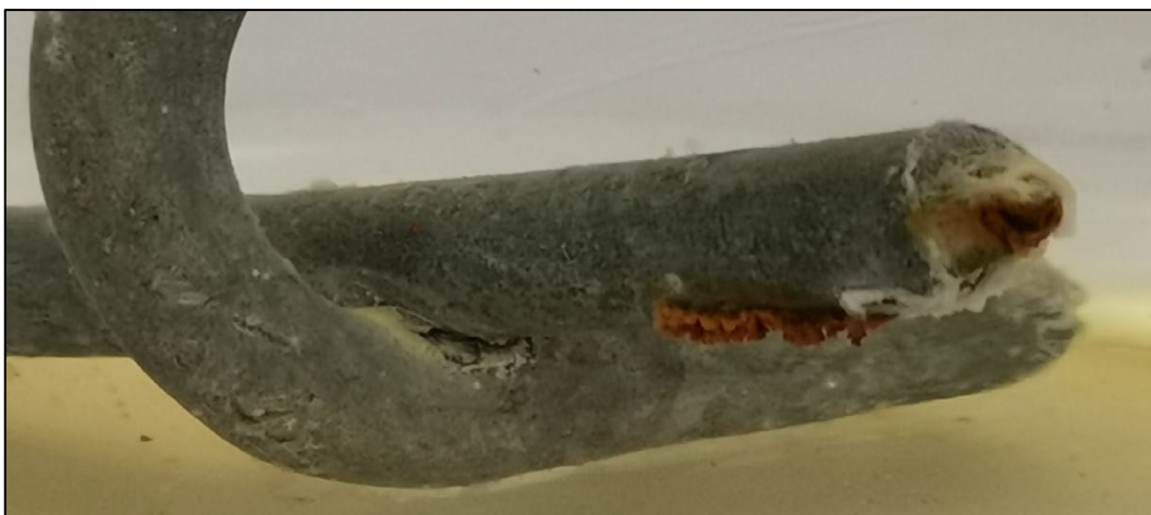
Slika 8.52. Četvrti pregled – 15K+S – korozija zbog oštećenja brusnom pločom
