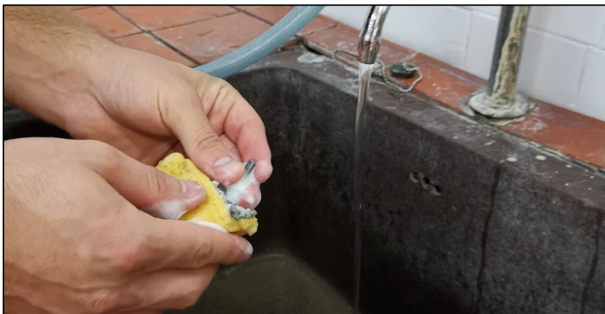
Slika 8.66. Skidanje korozivskog produkta s uzoraka žice
