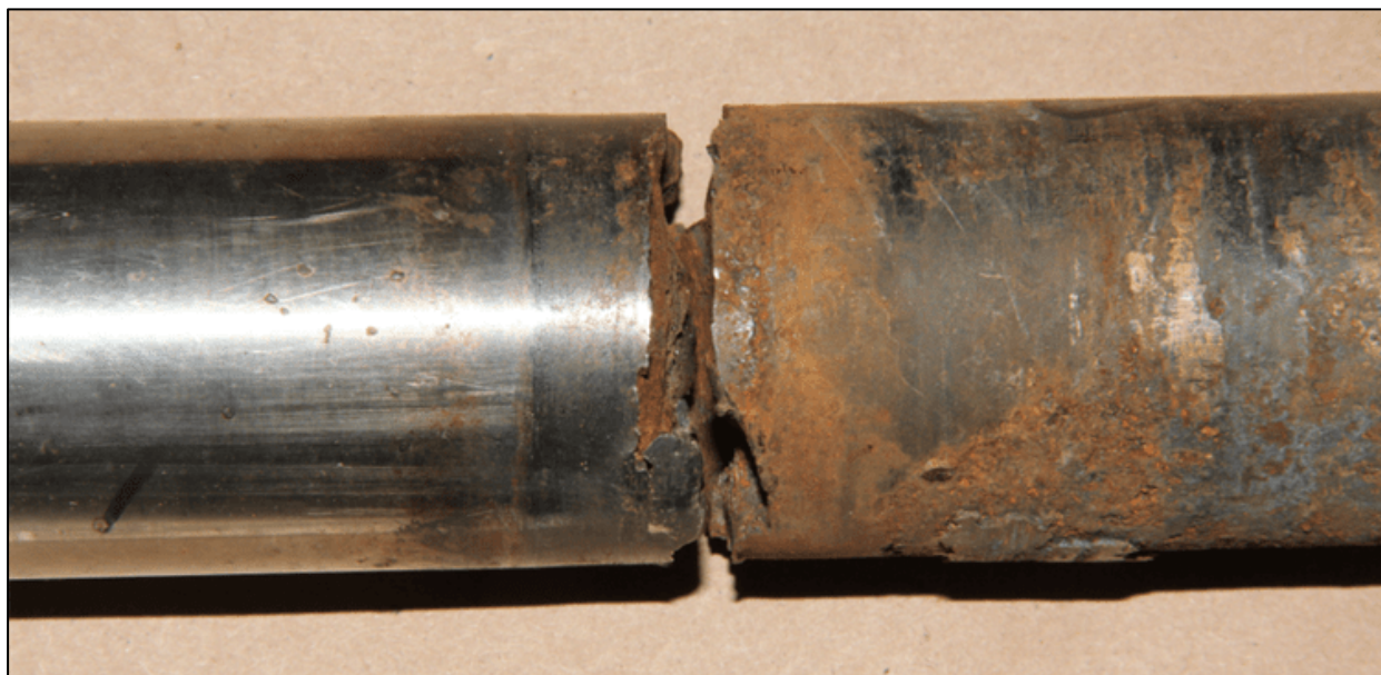
Slika 5.26. Lom vratila uzrokovan korozijskim zamorom [57]
