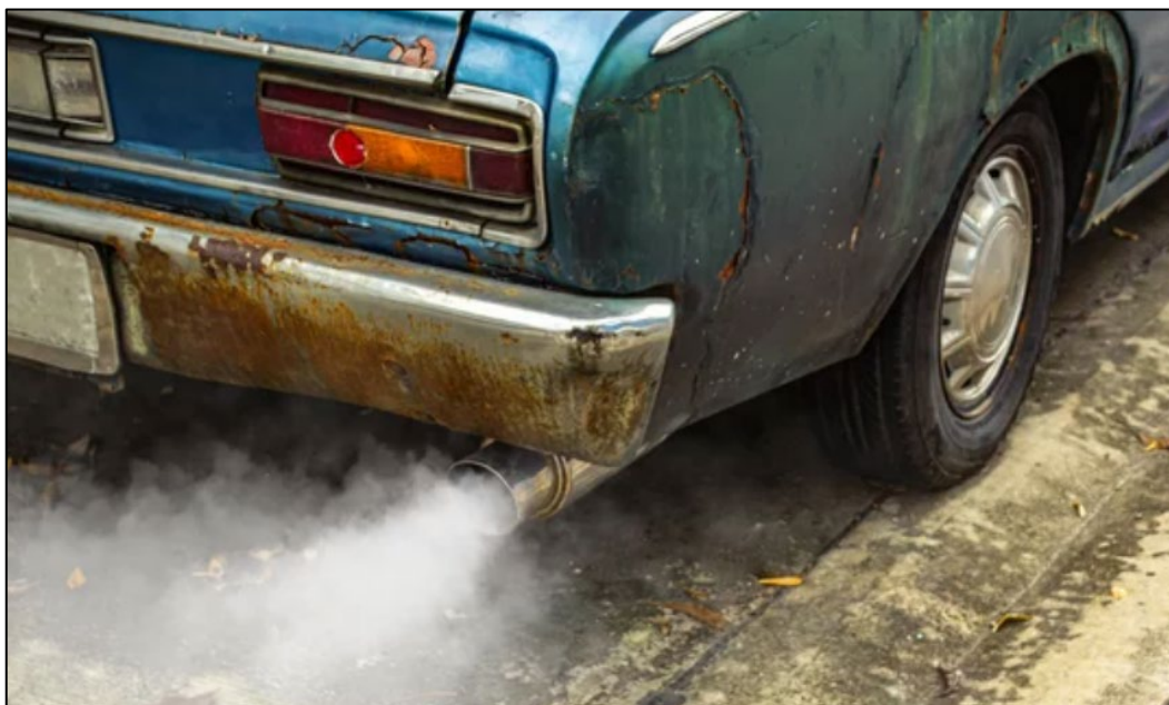
Slika 4.10. Korozija automobila u gradskoj atmosferi [23]
