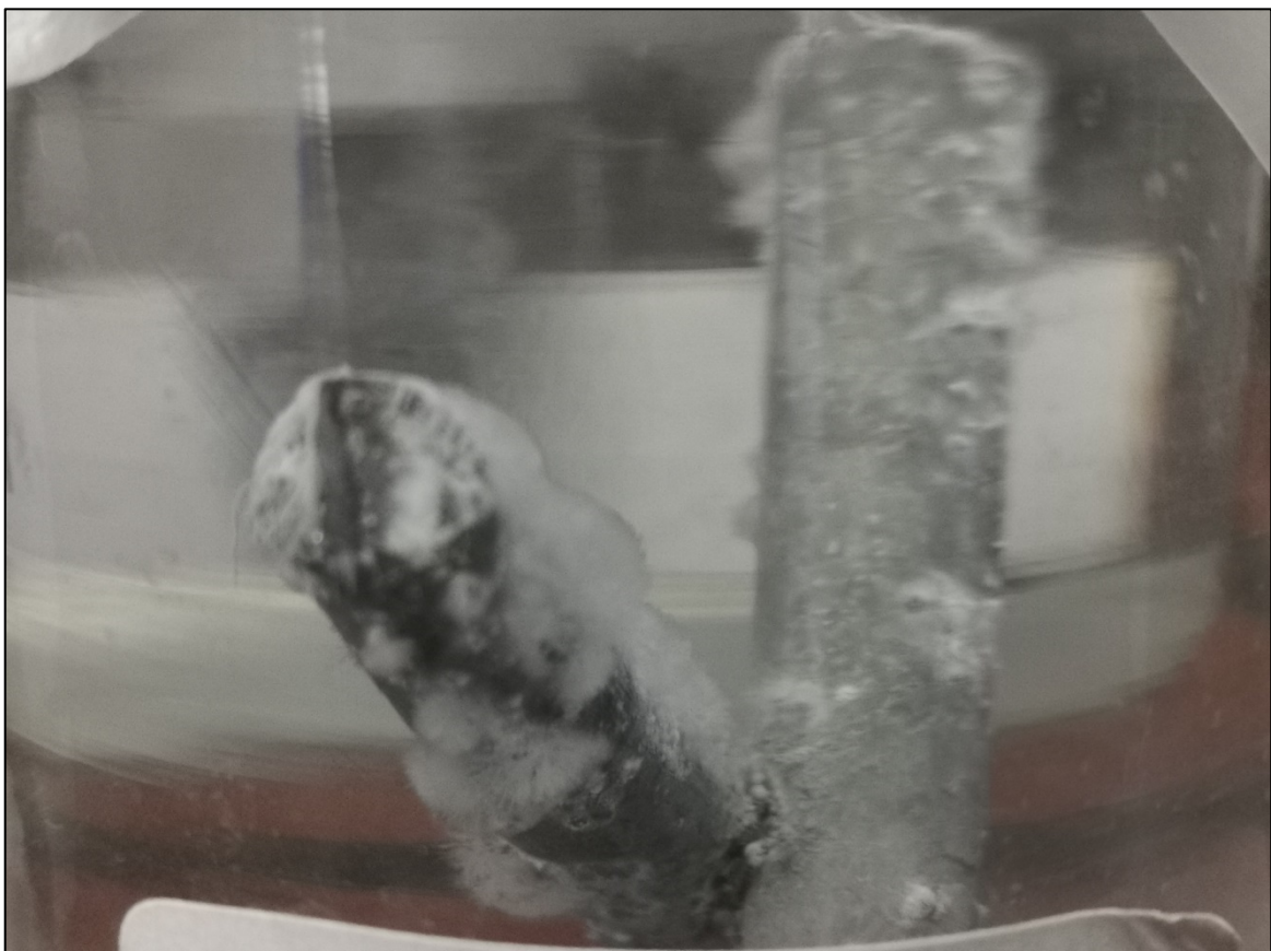
Slika 8.44. Drugi pregled – 15K – veće količine bijele korozije
