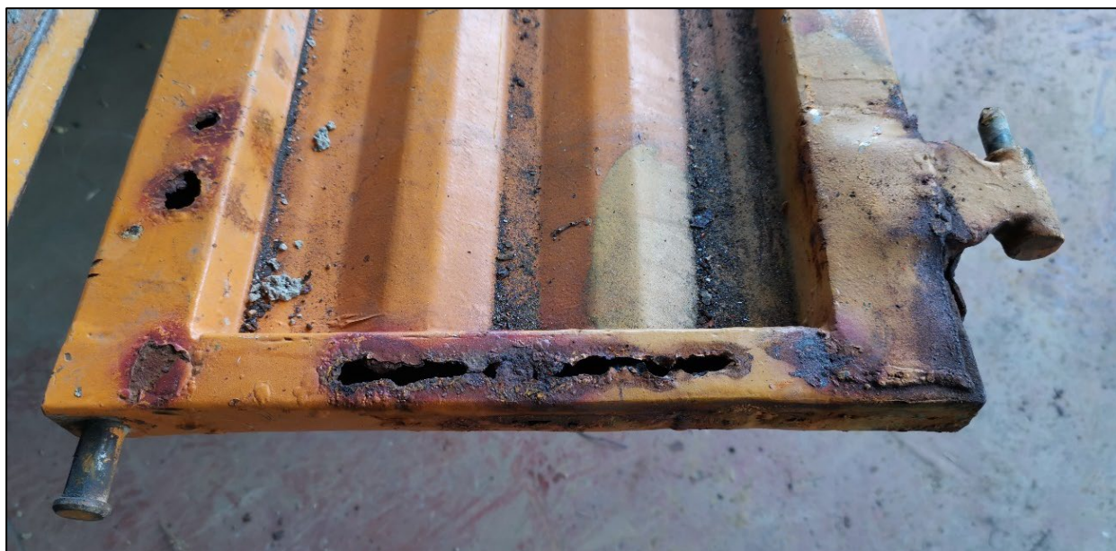
Slika 2.4. Korodirani dijelovi stranice dostavnog vozila [11]
