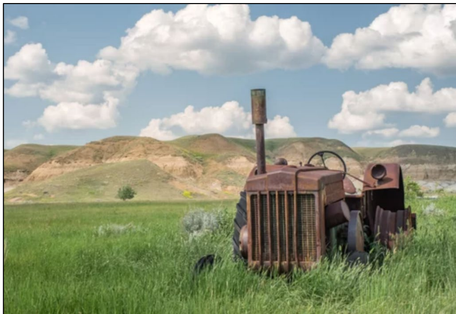
Slika 4.11. Korozija traktora u ruralnoj atmosferi [24]
