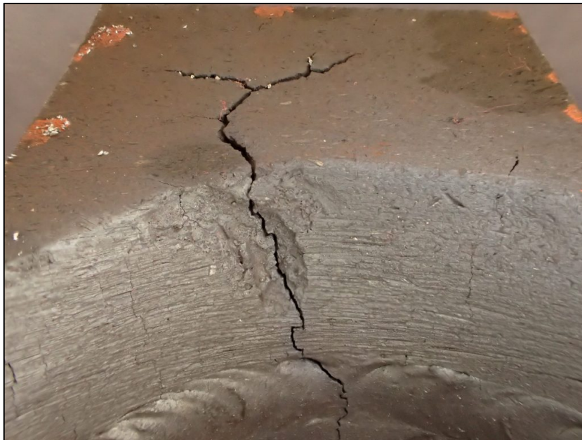
Slika 5.25. Oštećenje napetosnom korozijom pored zavora [56]
