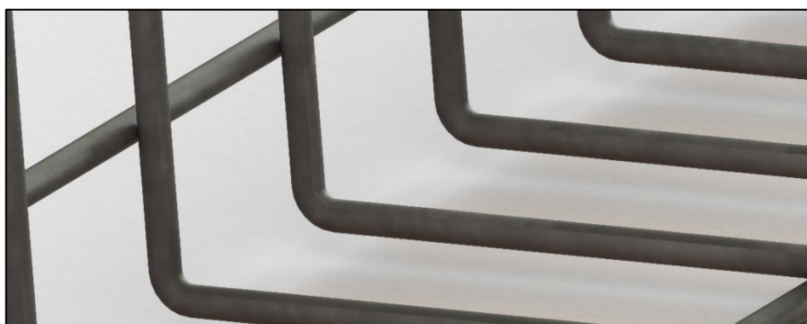
Slika 7.16. Savijanje čelične mreže pod 90^\circ
