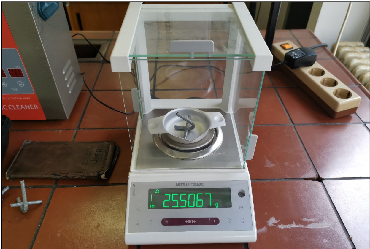
Slika 8.23. Mjerenje početne mase uzorka 15K+S
