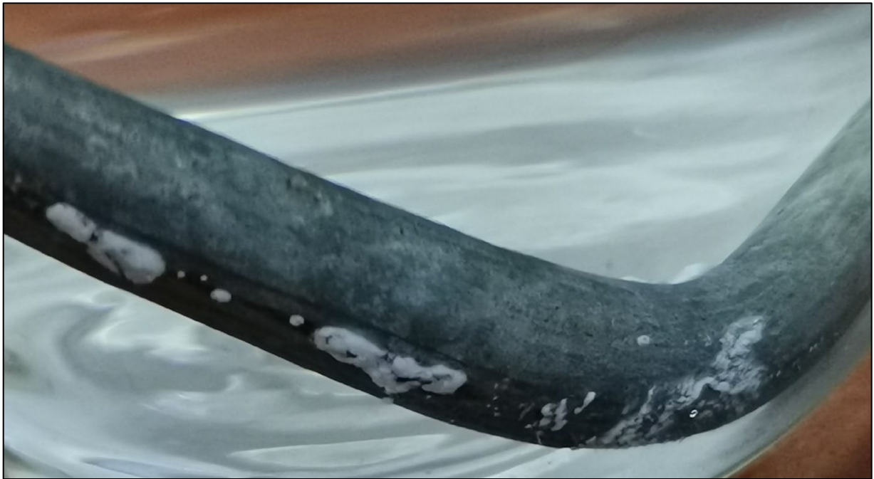
Slika 8.41. Prvi pregled – 16S - bijela korozija cinka na slabim točka žice
