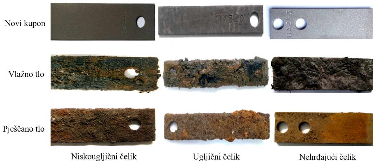
Slika 4.25. Korozijski kuponi različitih materijala u korozivnim okolinama [38]
