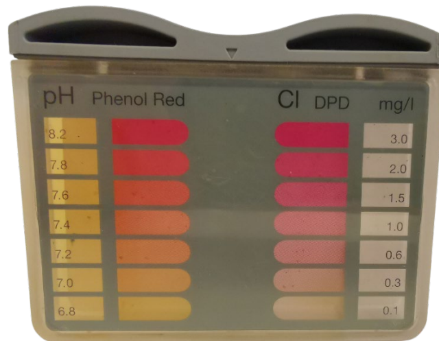
Slika 8.39. Mjerenje pH-vrijednosti destilirane vode reagens tabletama PHENOLRED
