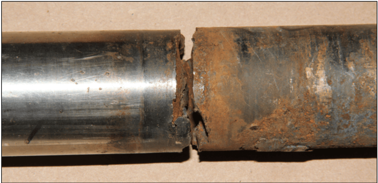
Slika 5.26. Lom vratila uzrokovan korozijskim zamorom [57]
