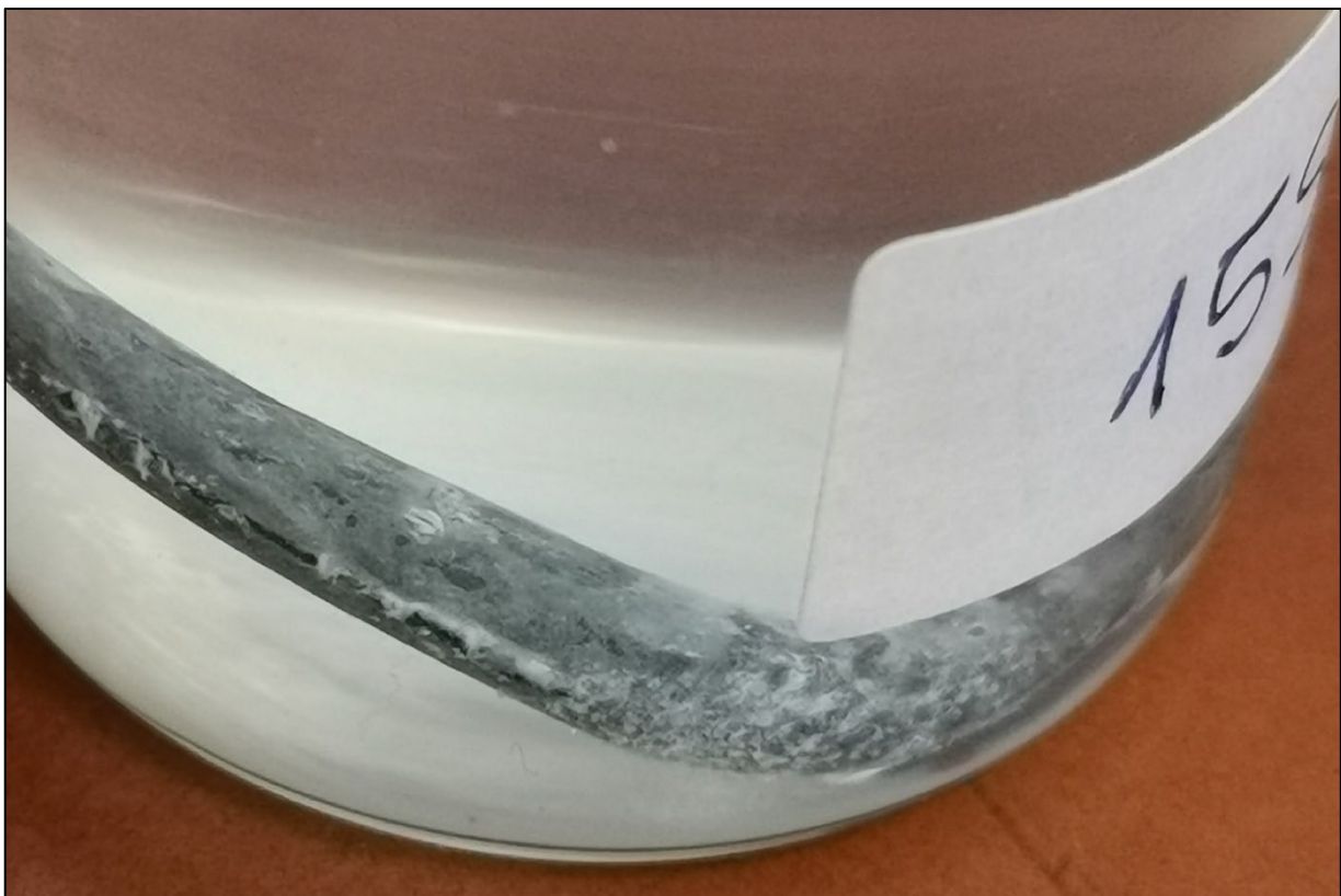
Slika 8.42. Prvi pregled – 15S - bijela korozija cinka
