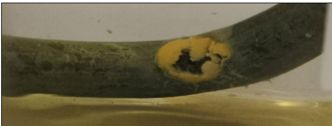
Slika 8.51. Četvrti pregled – 16S – znakovi bijele korozije cinka na mjestu savijanja žice
