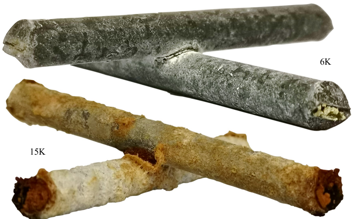
Slika 8.67. Usporedba uzoraka 6K i 15K na kraju eksperimenta
