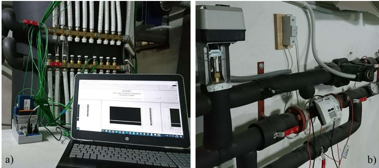
Slika 3.2. Dijelovi ispitne linije, a) latentni spremnik topline i sustav za prikupljanje podataka, b) regulacija ulazne temperature i protoka vode
