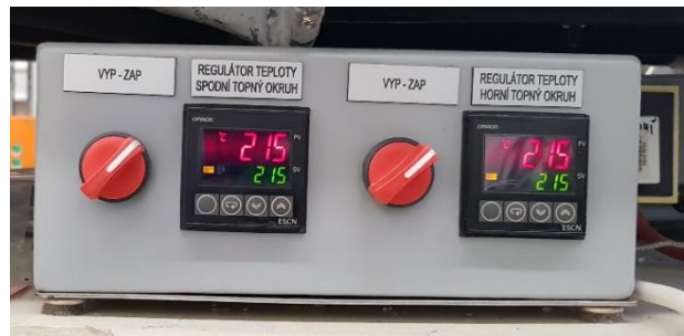
Slika 5.10 Prikaz radnih parametara ručne preše
