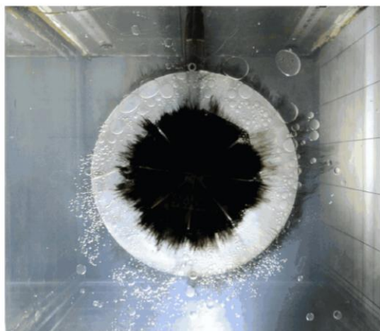
Slika 1.9. Utjecaj postavljanja poprečnih pregrada na kvalitetu protoka u radijalnom pločastom difuzoru [41]
