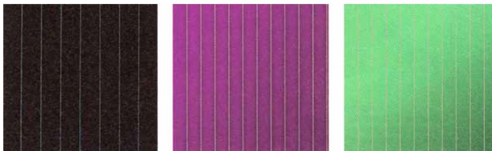
Slika 2. 6. Različite izvedbe solarnih ćelija: lijevo – solarna ćelija od bakar-indij-diselenida (CIS), sredina – solarna ćelija od amornog silicija, desno – solarna ćelija od kadmijeva telurida (CdTe)
