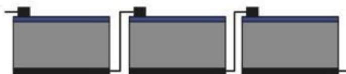
Slika 2. 11. Prikaz mogućeg načina serijskog spajanja solarnih ćelija
