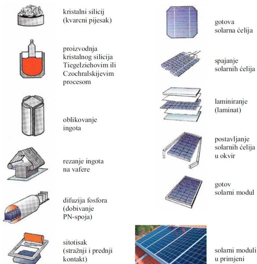
Slika 2. 7. Proces proizvodnje solarnih ćelija
