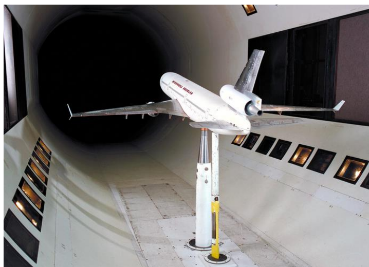
Slika 1.2 Fizička simulacija modela aviona [2]
