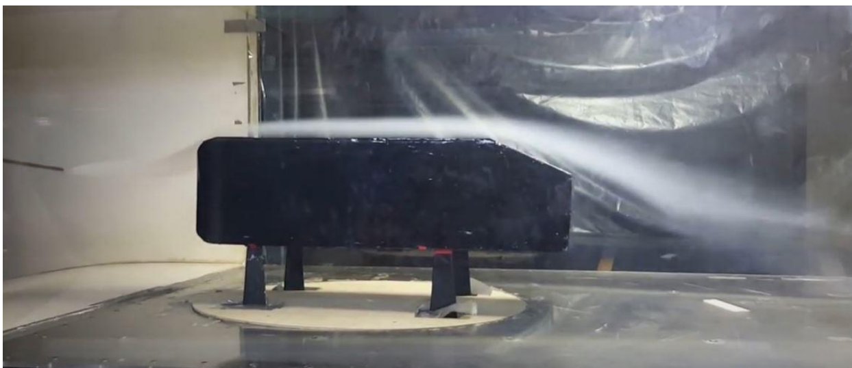
Slika 4.1 Prikaz fizičkog modela Ahmedovog tijela (preuzeto sa Google slika)
