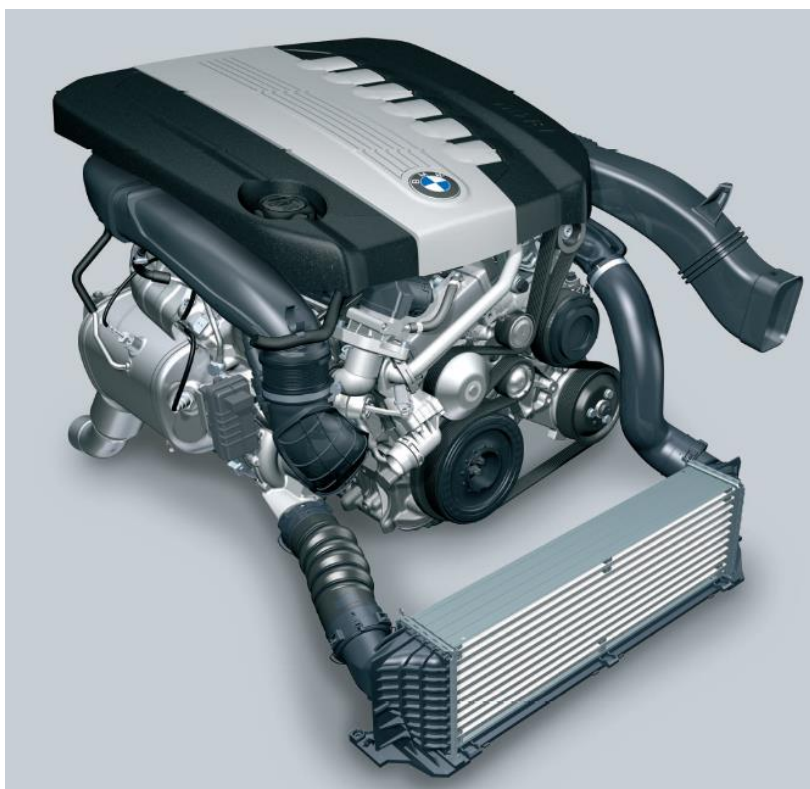
Slika 3.2 Motor N57D3000 s povezanim hladnjakom zraka za izgaranje [14]
