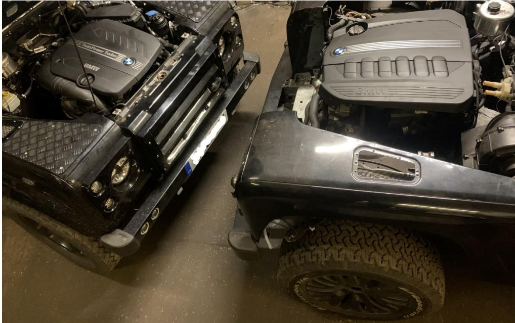
Slika 3.1 N57 serija pod poklopcem motora dva Defendera 110 [13]
