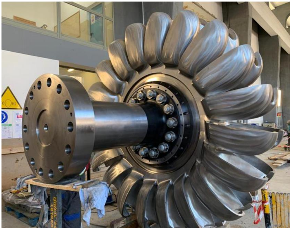
Slika 3.3. Rotor Pelton turbine s lopaticama [14]
