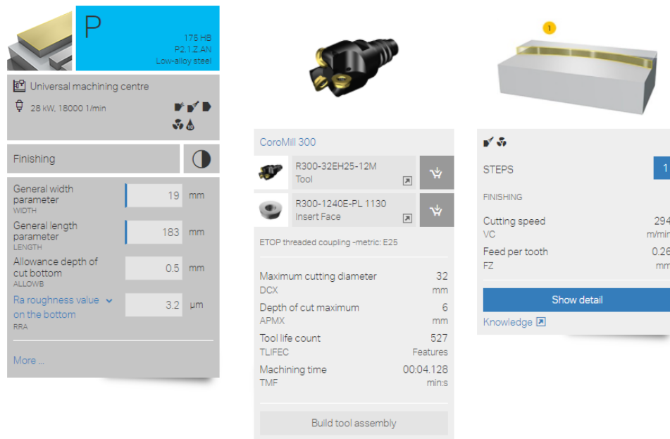
Slika 4.18 Izbor alata i režimi obrade - operacija 10, zahvat 11
