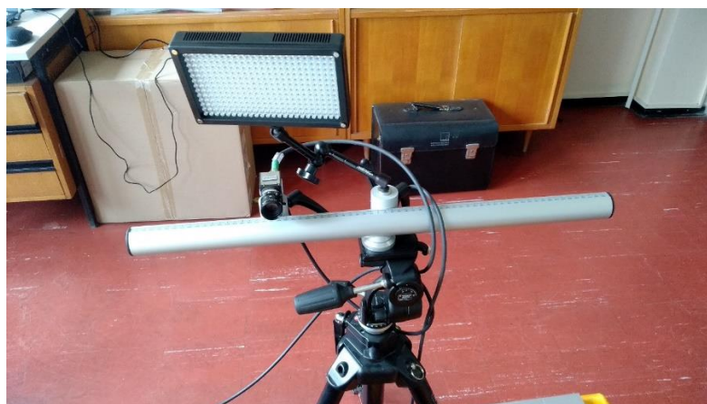
Slika 8.8: Postavljeni sustav za primjenu metode korelacije digitalne slike
