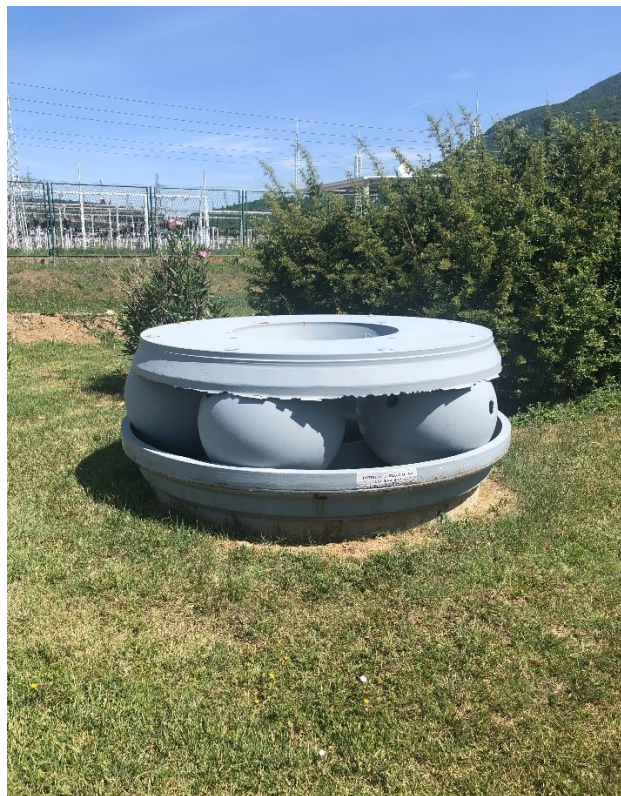
Slika 6.7. Radni mehanizam mlina koji služi za usitnjavanje ugljena u ugljenu prašinu
