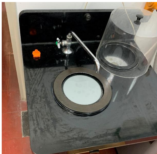
Slika 4.23. Radna stanica za brušenje
