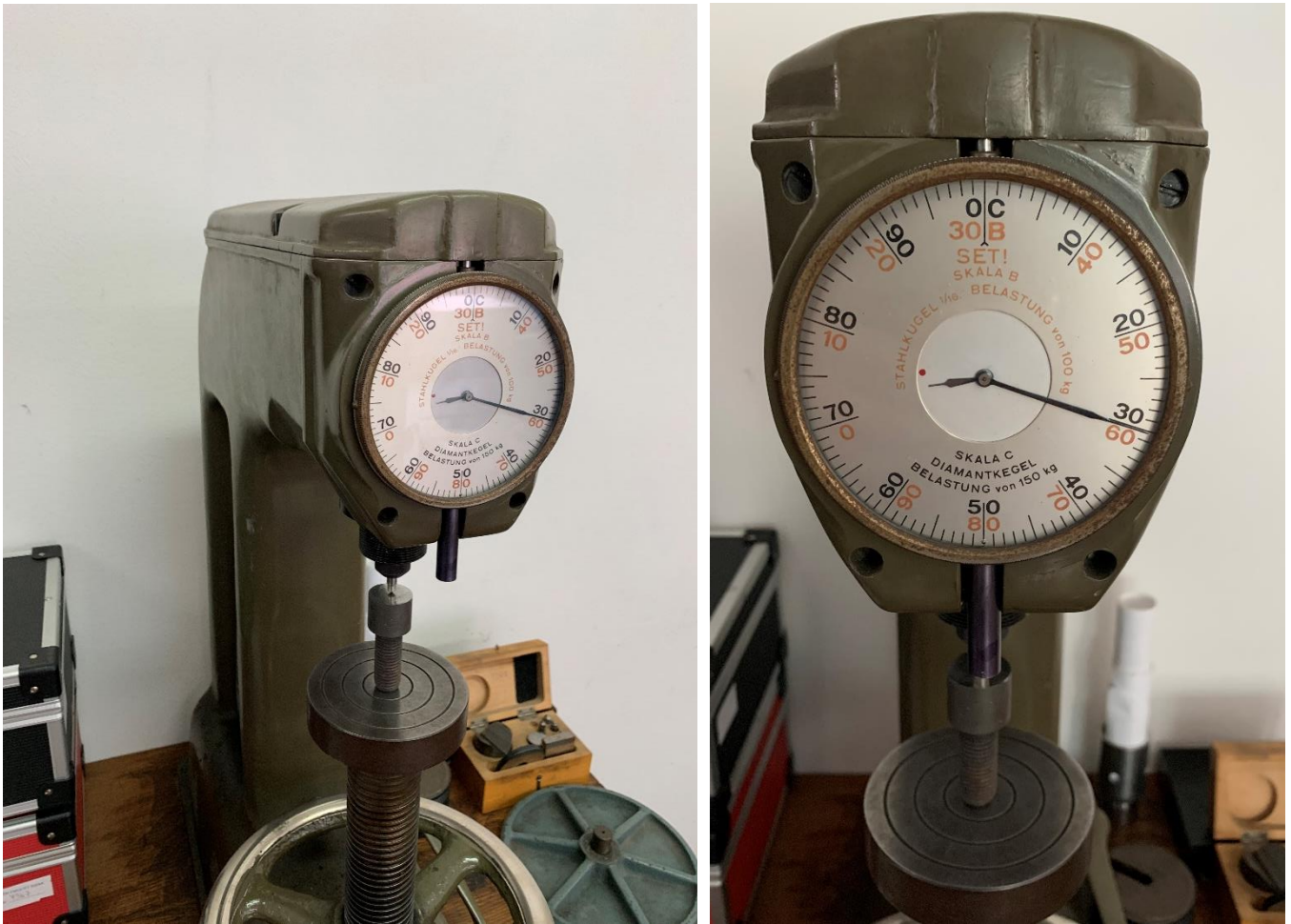
Slika 4.20. Ispitivanje tvrdoće jezgre nakon visokotemperaturnog popuštanja
