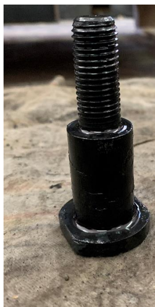
Slika 4.12. Izgled obratka nakon postupka kaljenja
