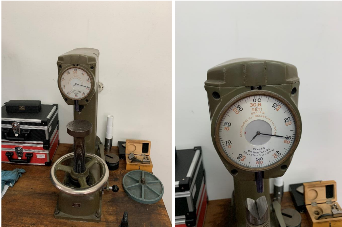
Slika 4.13. Uređaj za ispitivanje tvrdoće po Rockwellu
