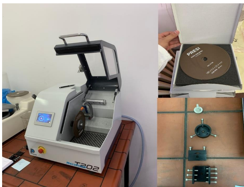
Slika 5.12. Mecatome T202, rezna ploča i stezne naprave
