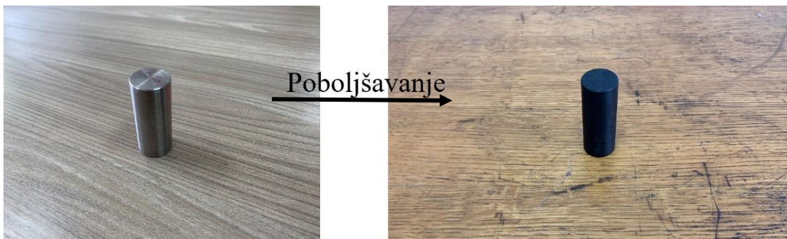
Slika 5.11. Strojni dio prije i poslije poboljšavanja
