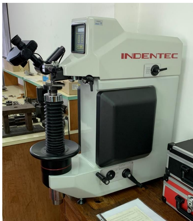
Slika 5.21. Uređaj za mjerenje tvrdoće
