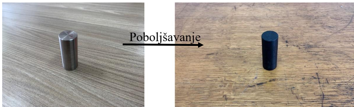
Slika 5.11. Strojni dio prije i poslije poboljšavanja
