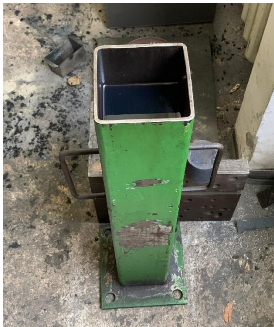
Slika 5.9. Improvizirana posuda za kaljenje
