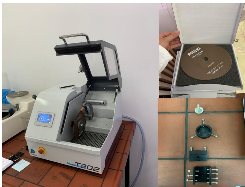
Slika 5.12. Mecatome T202, rezna ploča i stezne naprave
