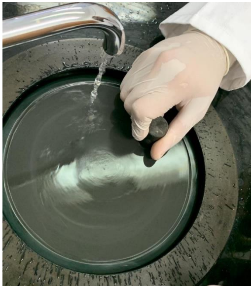
Slika 5.14. Uređaj za brušenje s pričvršćenim brusnim papirom
