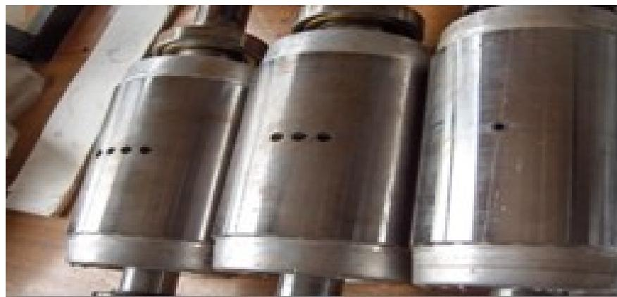
*Slika 8.2. Primjer kvara stroja (slomljene šipke rotora induksijskog stroja), Izvor: [10]*
