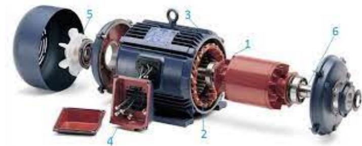
Slika 8.1. Dijelovi induksijskog stroja (1 - rotor, 2 - stator, 3 - kućište, 4 - kutija za priključak vodiča, 5 - ventilator, 6 - kućište ležaja), Izvor: [10]
