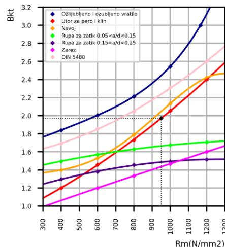
Slika 6.20.4 dijagram efektivnih faktora koncentracije naprezanja za torziju različitim presjeka vratila
