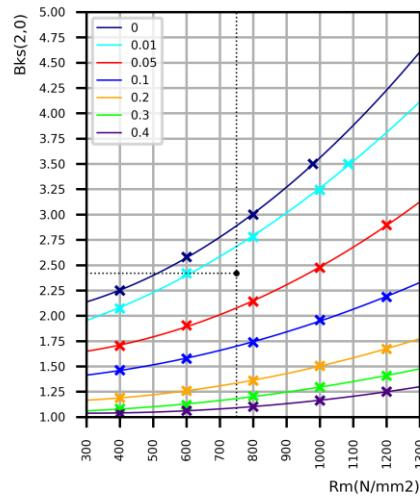
Slika 6.19.1 dijagram efektivnih faktora koncentracije naprezanja kod promjene promjera vratila
