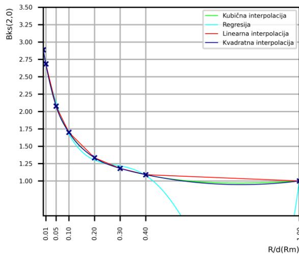
Slika 6.19.2 usporedba regresije i interpolacije za savijanje
