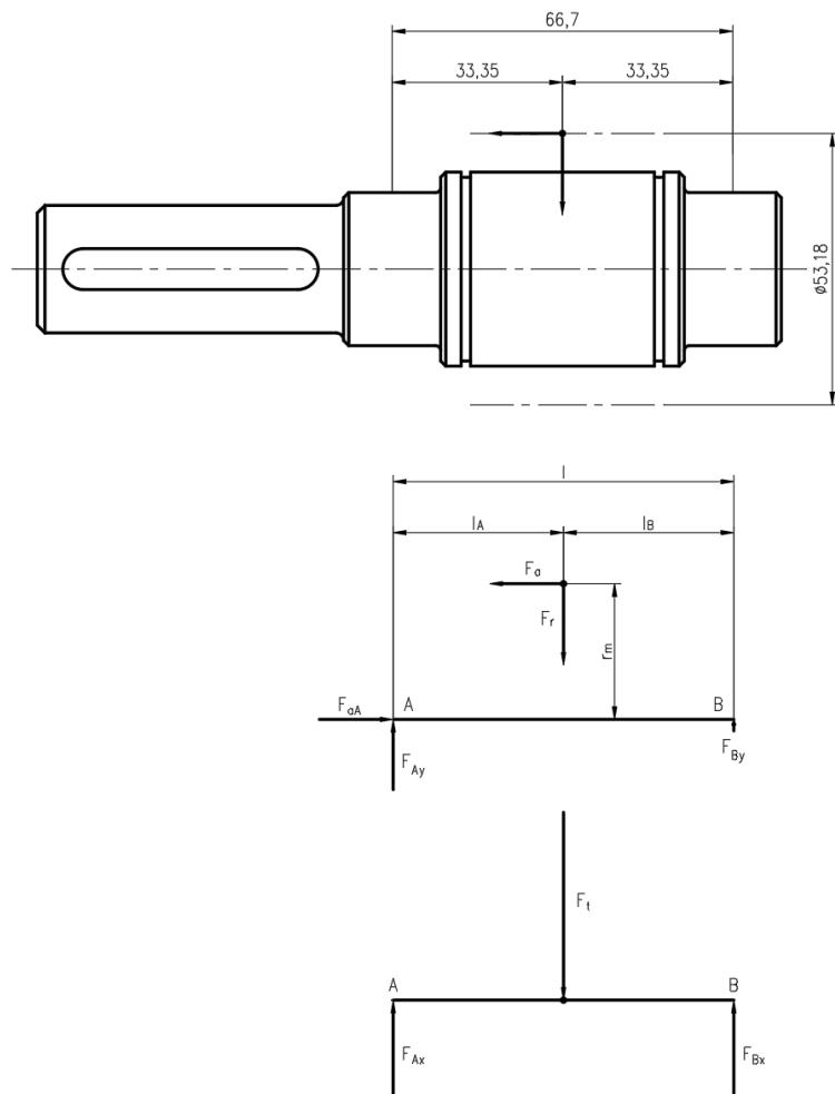
*Slika 4.1.1 Sile u horizontalnoj i vertikalnoj ravnini*
