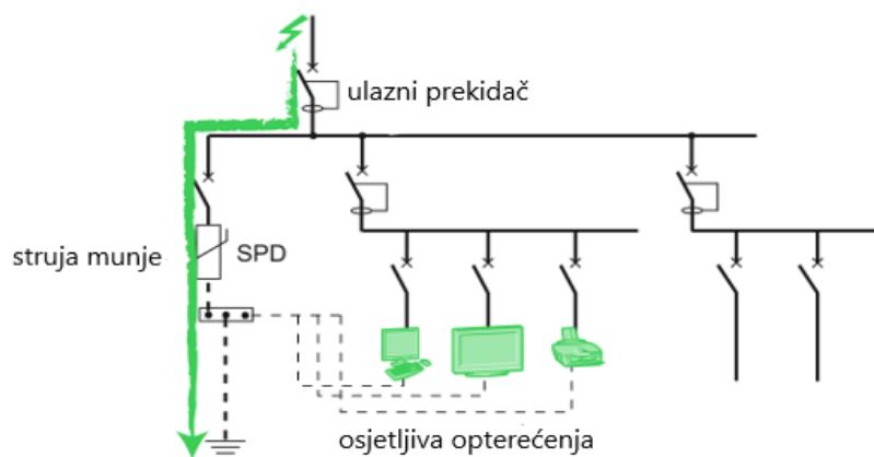
*Slika 4. Uređaj za zaštitu od prenapona*
