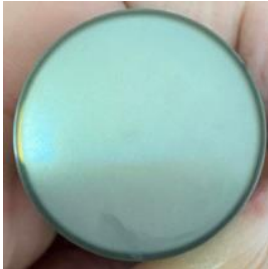
Slika 4.13. Strojni dio MJ.22-DT.39 nakon brušenja i poliranja
