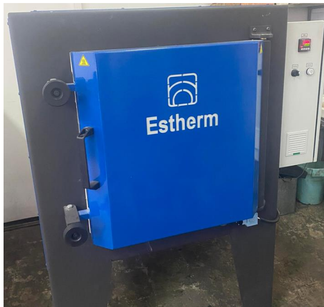
Slika 4.5. Peć za žarenje, tip "KER 175"
