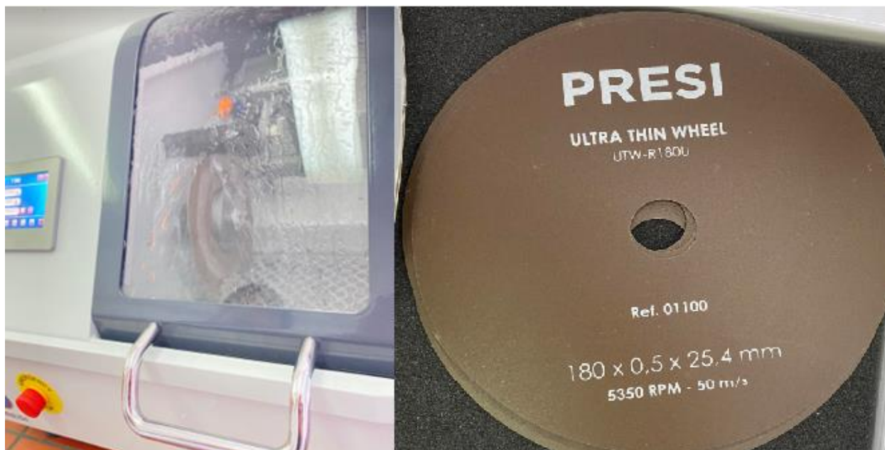
Slika 4.11. Odrezivanje strojnog dijela MJ.22-DT39 i korišteni rezni kotač
