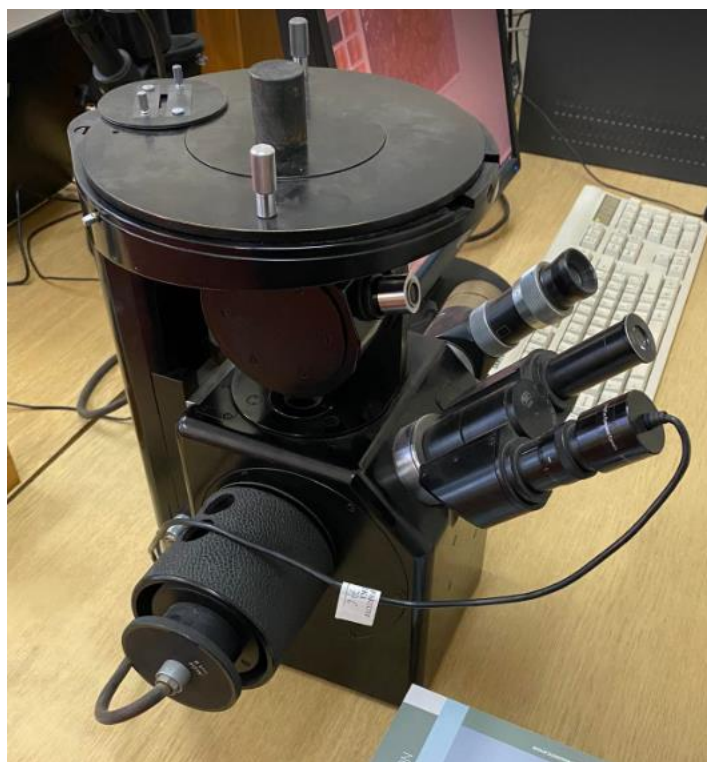
Slika 4.7. Metalografski mikroskop "Carl Zeiss"
