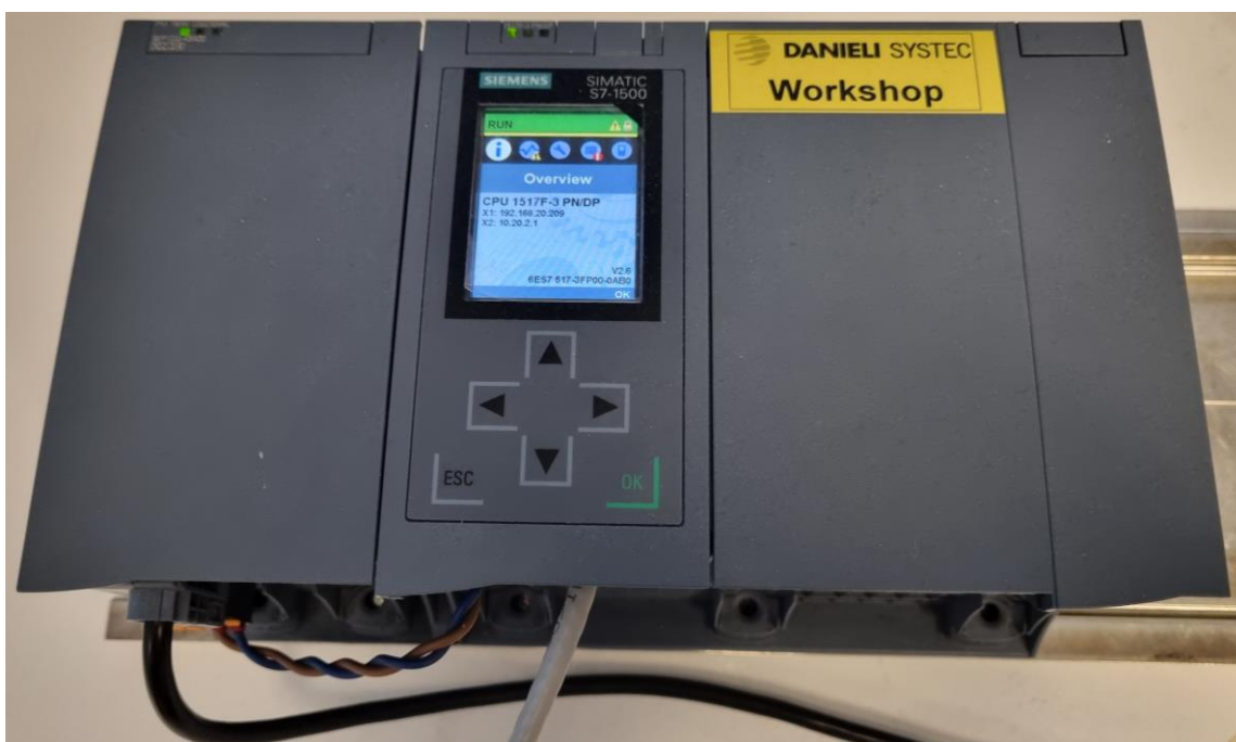
Slika 4.2.2. PLC korišten u ovom radu. Jedinica se sastoji od zasebnih elemenata (kartica), s lijeva na desno: napajanje i CPU
