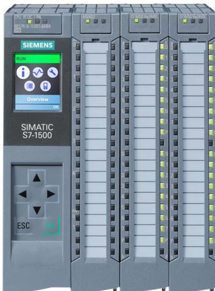
Slika 3.1. Primjer PLC-a proširenog s 3 dodatna modula
