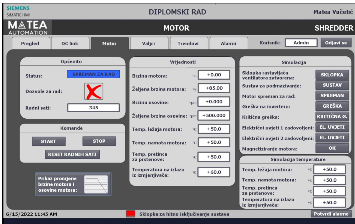
Slika 5.20. Izgled kartice „Motor“ nakon što se zada komanda za zasutavljanje sustava te se i motor zaustavio
