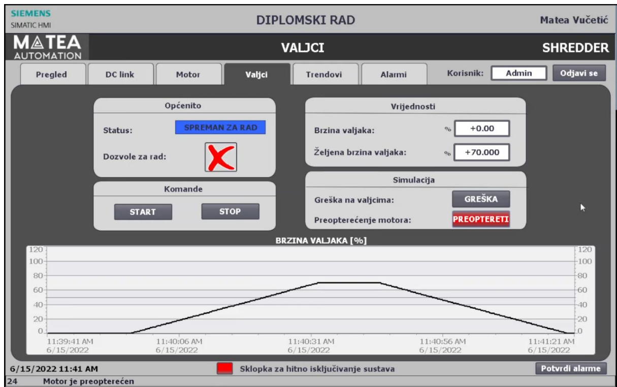
Slika 5.14. Prikaz kartice „Valjci“ kada je simulirano preopterećenje motora
