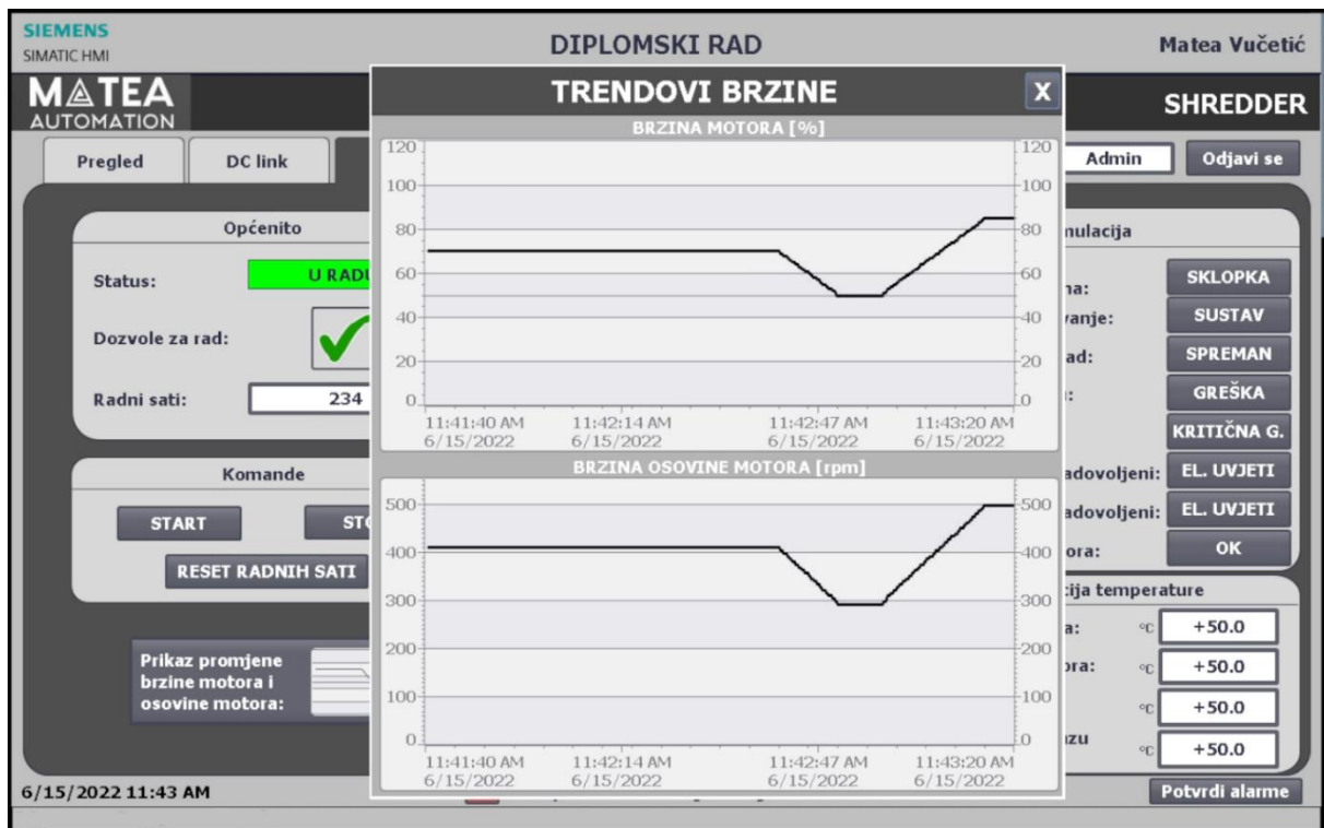
Slika 5.18. Prikaz promjene trendova brzine kada se željen abrzina rotora motora prvo promjeni sa 70% na 50%, te se potom željena brzina osovine postavi na 500 rpm
