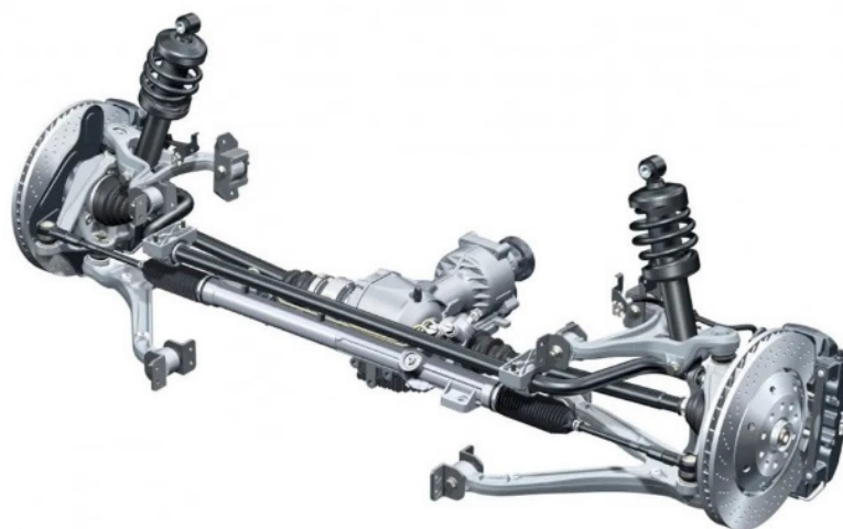
Slika 2.26 Općeniti nezavisni ovjes s dvostrukim vilicama, kočnicama i diferencijalom [21]
