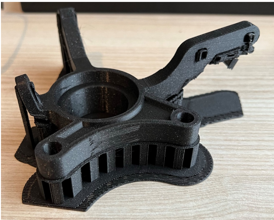
Slika 6.3 3D printani model kućišta ležaja kotača
