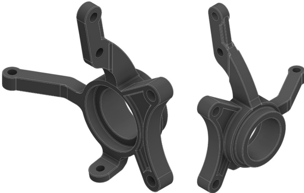
Slika 5.8 Modelirano kućište ležaja kotača iz dva pogleda
