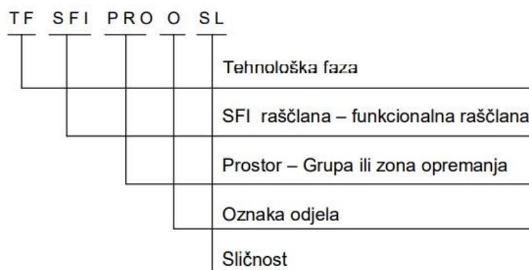
Slika 4.5. Klasifikacijska šifra radioničkog nacrtu [14]
