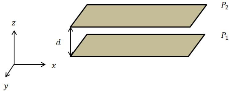
*Slika 5.1. Par paralelnih nabijenih ploča. Izvor: izradio autor.*
