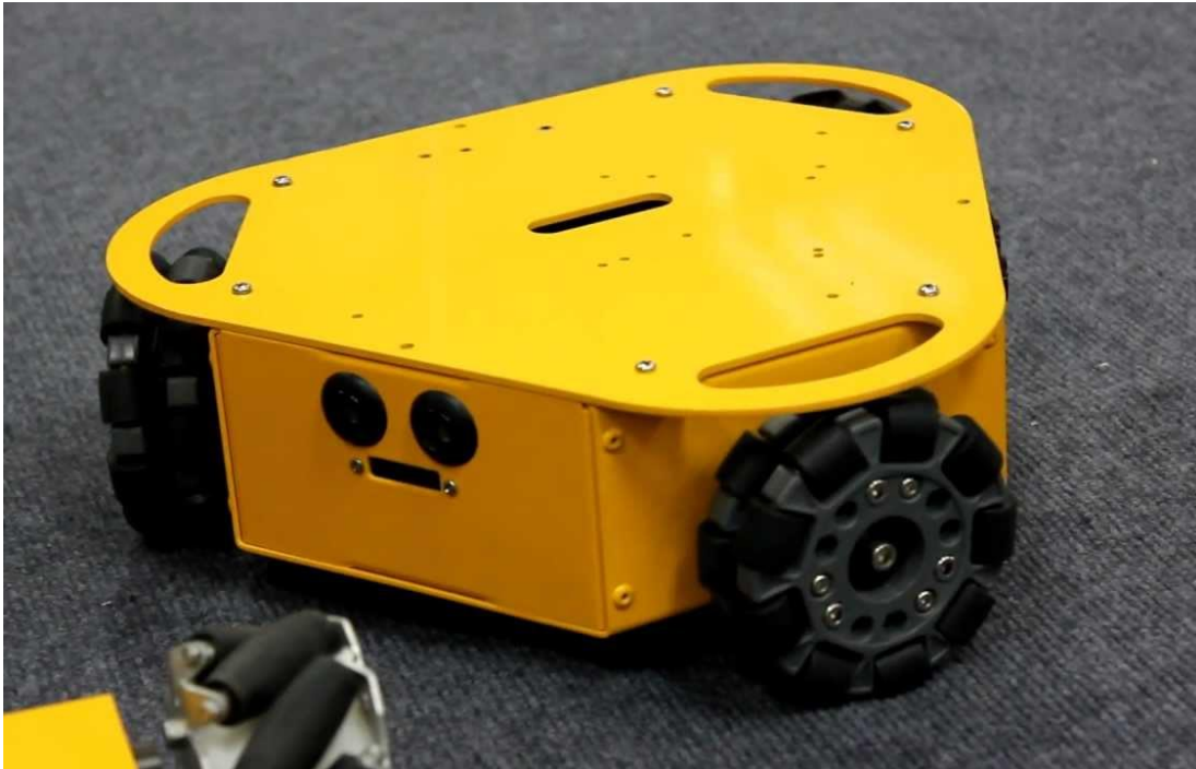
Slika 2.3. Mobilni robot sa svesmjernim pogonom [6]
