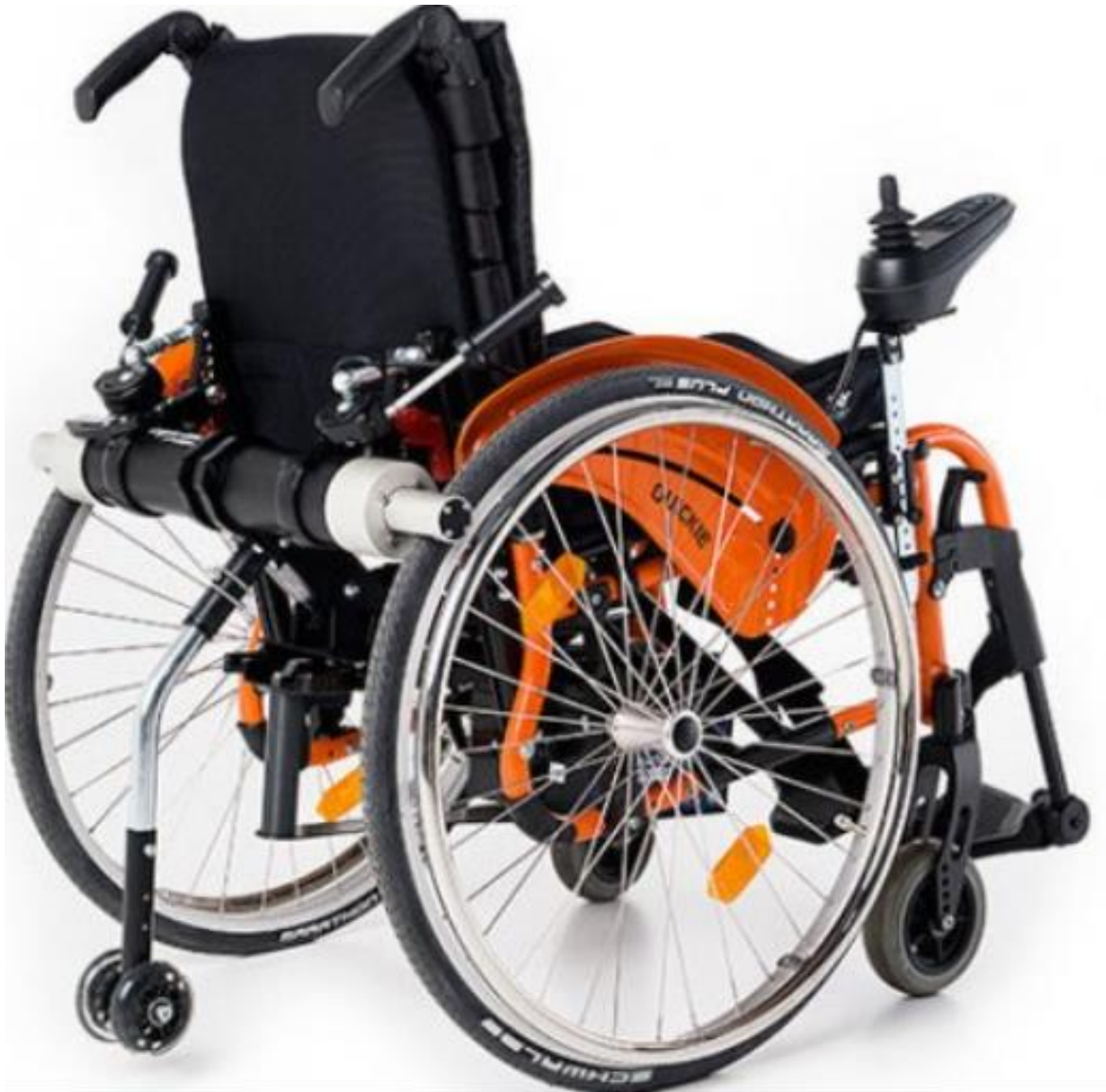
Slika 4.5. Pogonski dodatak za kolica „Light drive power assist“ [19]
