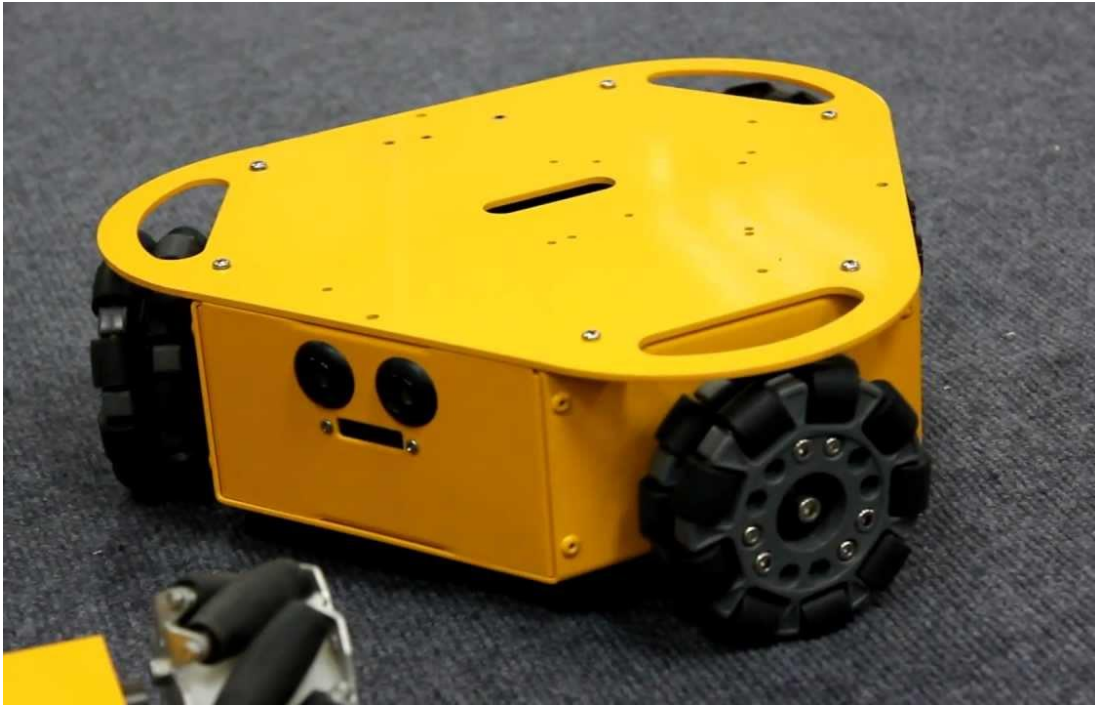
Slika 2.3. Mobilni robot sa svesmjernim pogonom [6]
