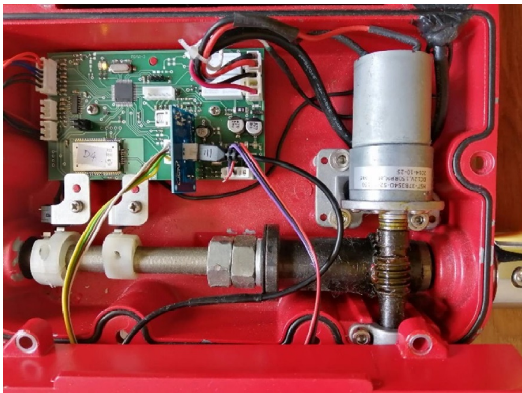
Slika 3.3: Unutrašnjost barijere sa sastavnim komponentama[14]
