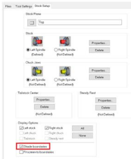
Slika 6.13 Uključivanje Shade boundaries
