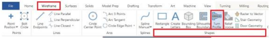
Slika 6.14 Naredba za prikaz konture
