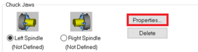
Slika 6.10 Naredba za definiranje čeljusti
