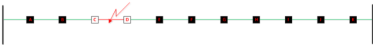
Slika 5.3. Rekonfigurirana mreža i spremna za ponovni uklop [2]
