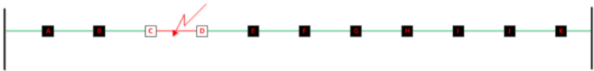
Slika 5.3. Rekonfigurirana mreža i spremna za ponovni uklop [2]
