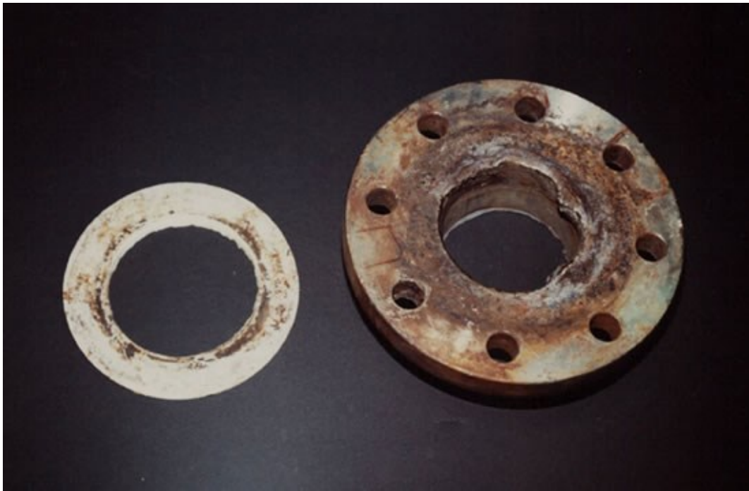
Slika 2.23. Korozija u procjepu ispod brtve na prirubnici od nehrđajućeg čelika [27]
