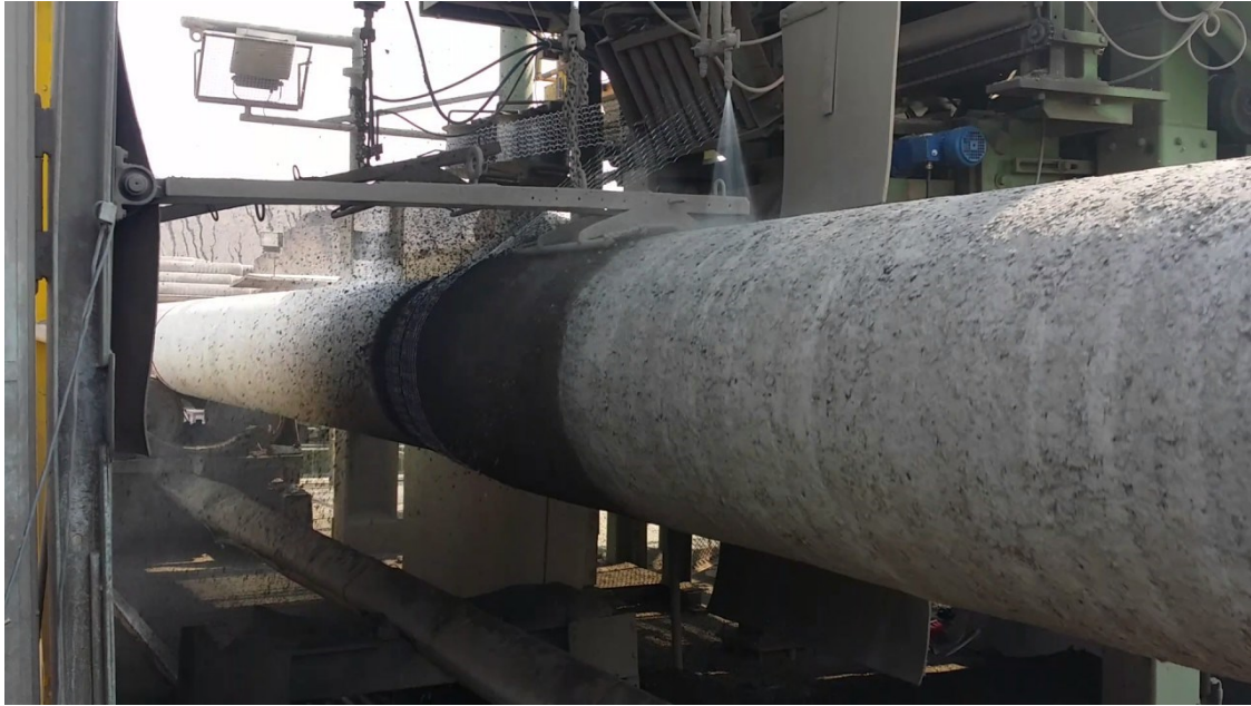
Slika 3.8. Prikaz cementiranja cijevi [43]
