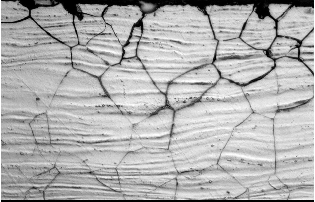
Slika 2.26. Primjer interkristalne korozije [32]
