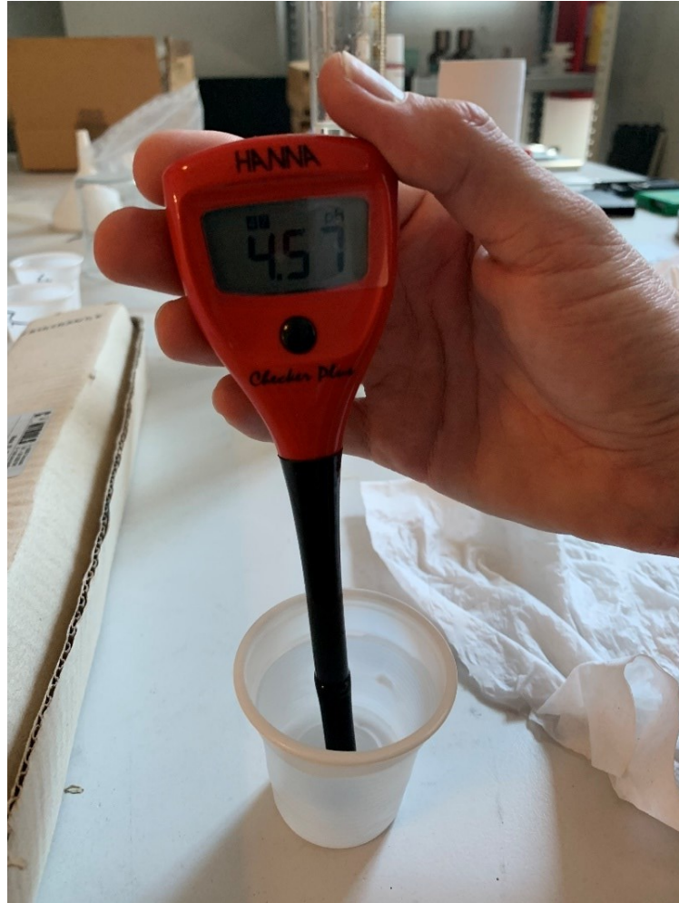
Slika 5.40. pH vrijednost prikupljene maglice nakon 168 sati rada slane komore
