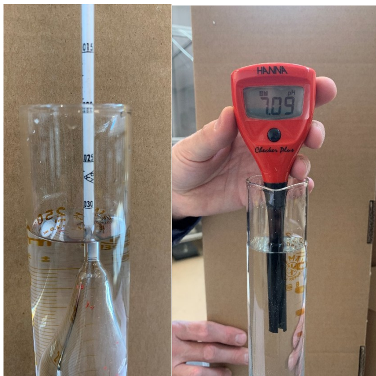
Slika 5.28. Očitanje gustoće i pH otopine
