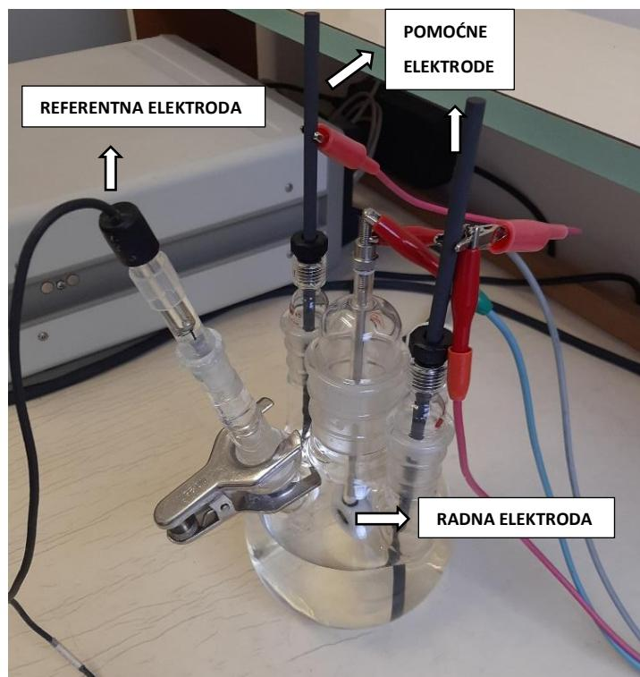
Slika 6.12. Peterogrena ispitna čelija s radnom, referentnom i pomoćnim elektrodoma
