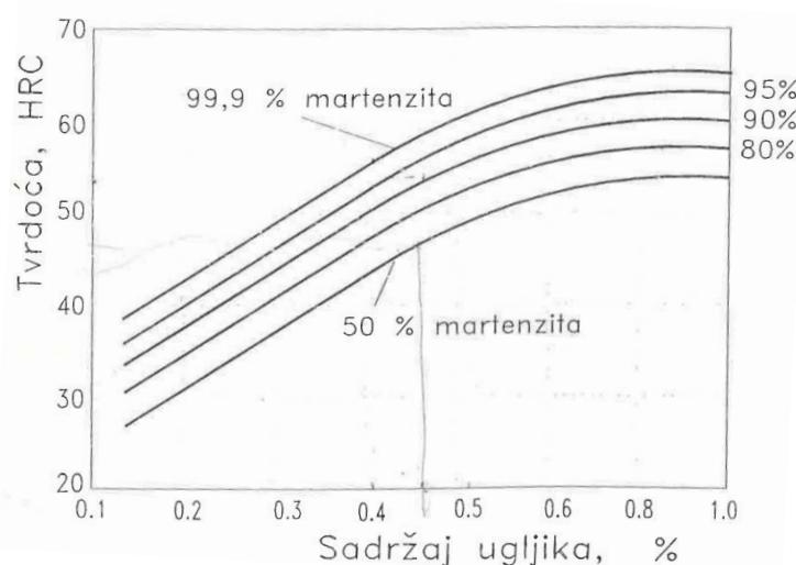
Slika 6.7. Burnsov dijagram ovisnosti tvrdoće i udjela ugljika martenzitne mikrostrukture [54]
