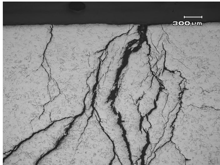
Slika 3.17. Razgranati oblik oštećenja izazvan napetosnom korozijom [38]
