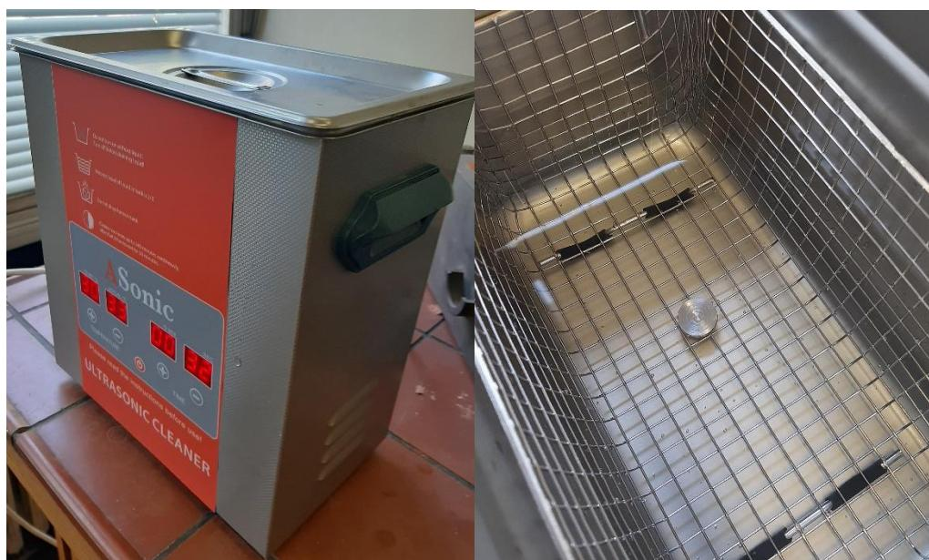
Slika 6.10. Čišćenje uzorka u ultrazvučnoj kupelji „ASonic PRO 30“
