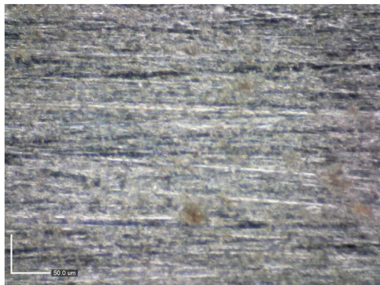
Slika 6.16. Brušena (nekorodirana) površina uzorka u normaliziranom stanju
