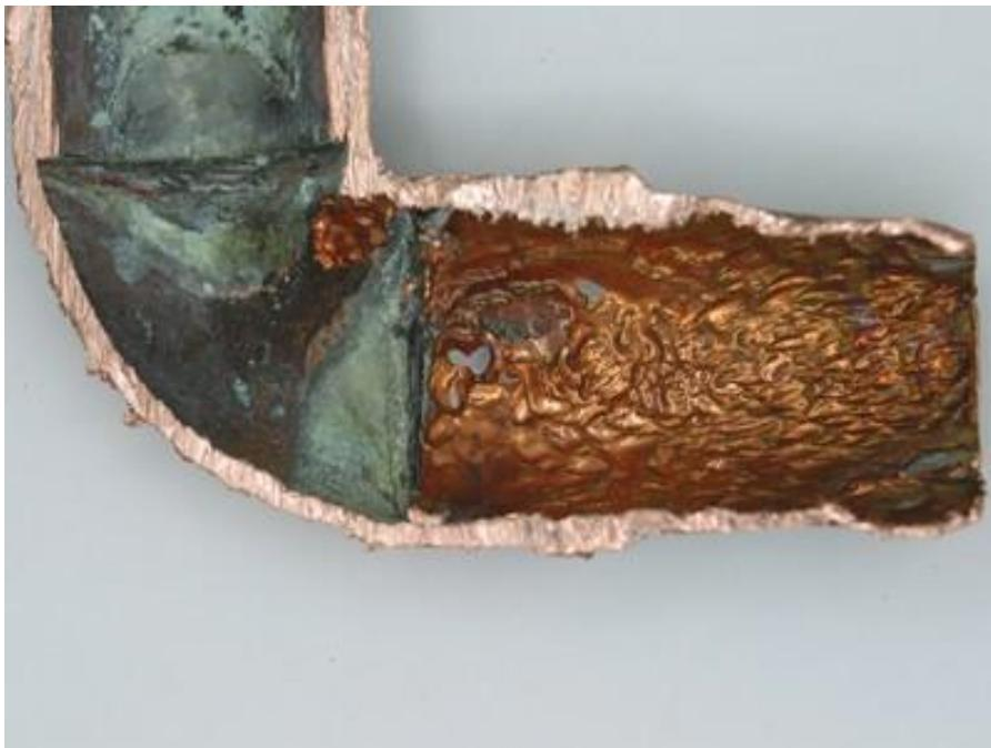
Slika 3.20. Erozijska korozija unutrašnjosti bakrene cijevi [41]
