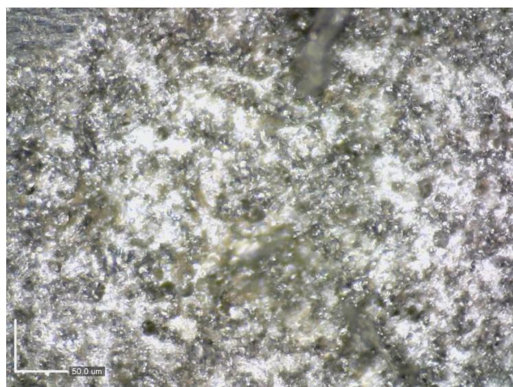
Slika 6.17. Korodirana površina uzorka u normaliziranom stanju
