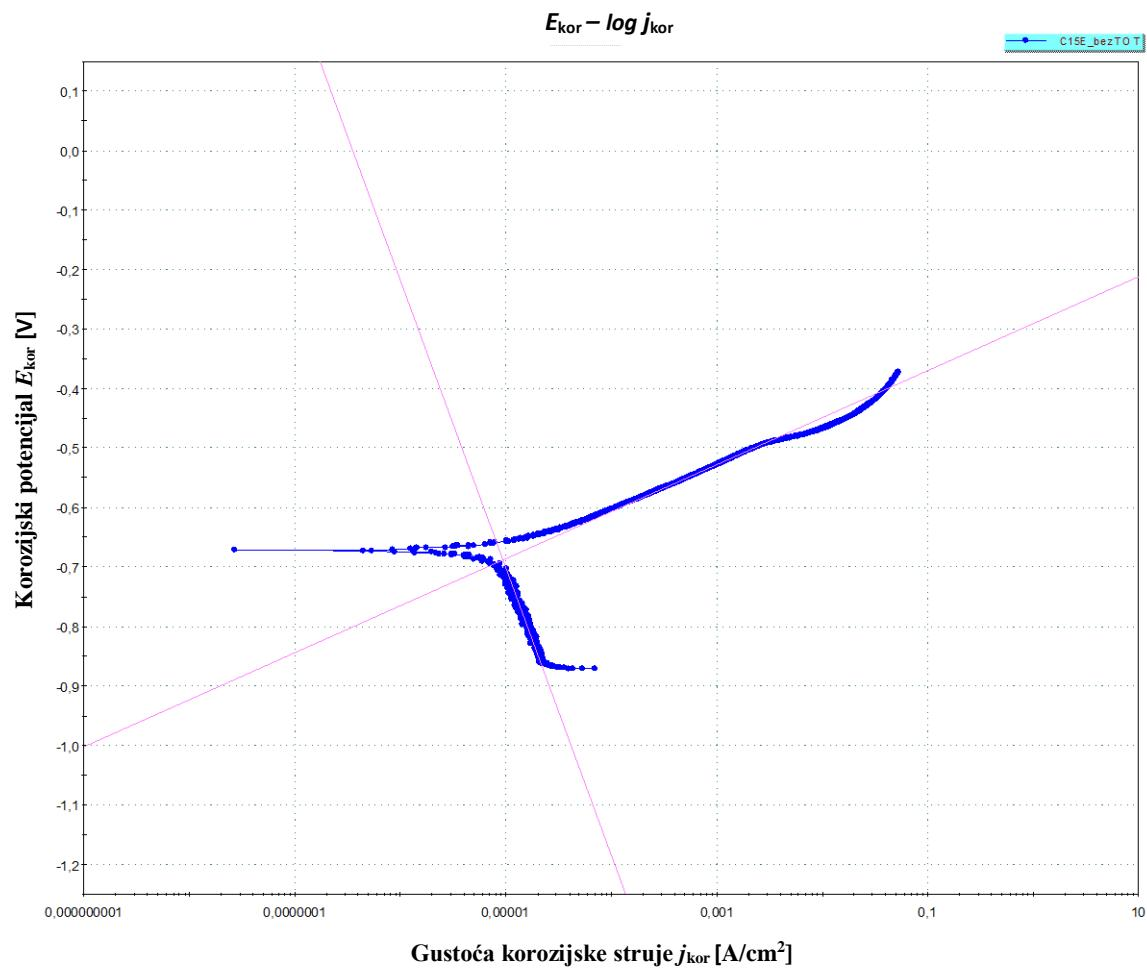
Slika 6.15. Ovisnost koroziskog potencijala o gustoći koroziskske struje – uzorak u normaliziranom stanju
