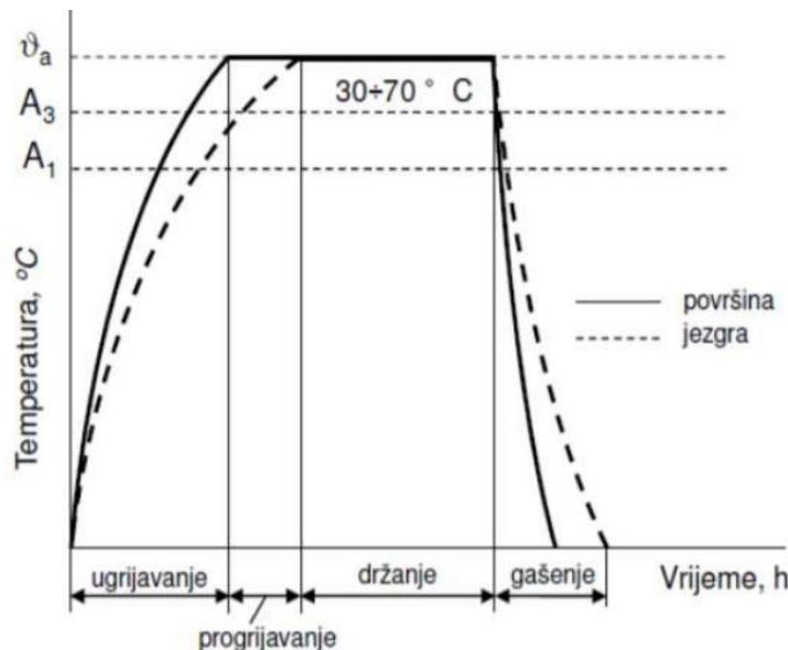
Slika 5.5. Dijagram postupka kaljenja podeutektoidnog čelika [49]
