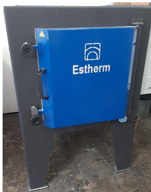
Slika 6.5. Peć za toplinsku obradu „Estherm“
