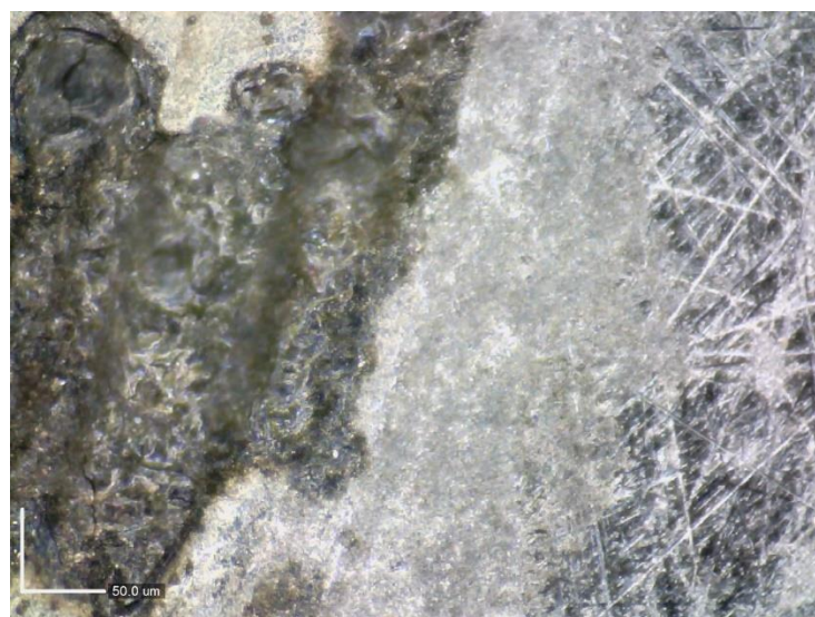
Slika 6.23. Prijelaz između brušene i korodirane površine cementiranog uzorka
