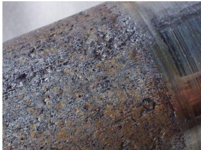
Slika 3.22. Korozija vanjske površine cijevi nastala djelovanjem lutajućih struja [43]
