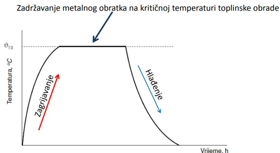
Slika 5.1. Shematski dijagram postupka toplinske obrade metalnog izratka [49]
