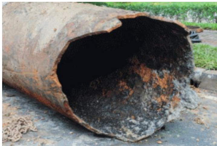
Slika 3.12. Grafitizacija ukopanog cjevovoda od sivog lijeva [32]
