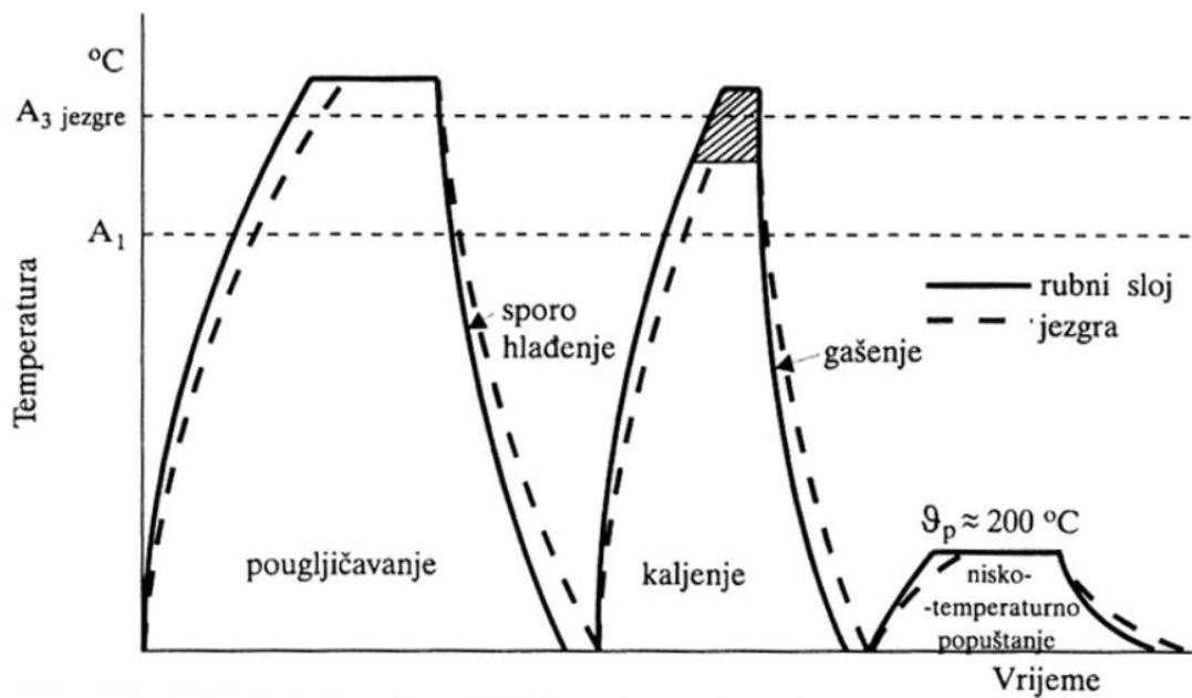
Slika 5.8. Dijagram postupka toplinske obrade cementiranja [52]
