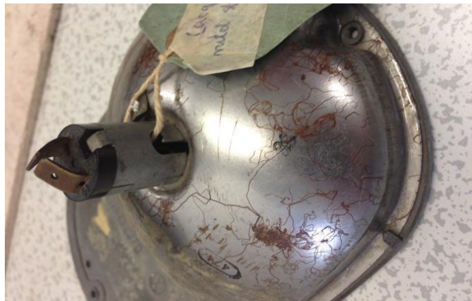
Slika 3.8. Filiformna korozija metalnog kućišta automobilskog svjetla [28]
