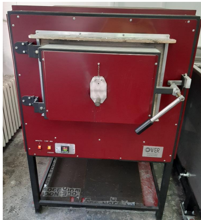
Slika 6.3. Peć za toplinsku obradu „OVER tip 0065-84-05“
