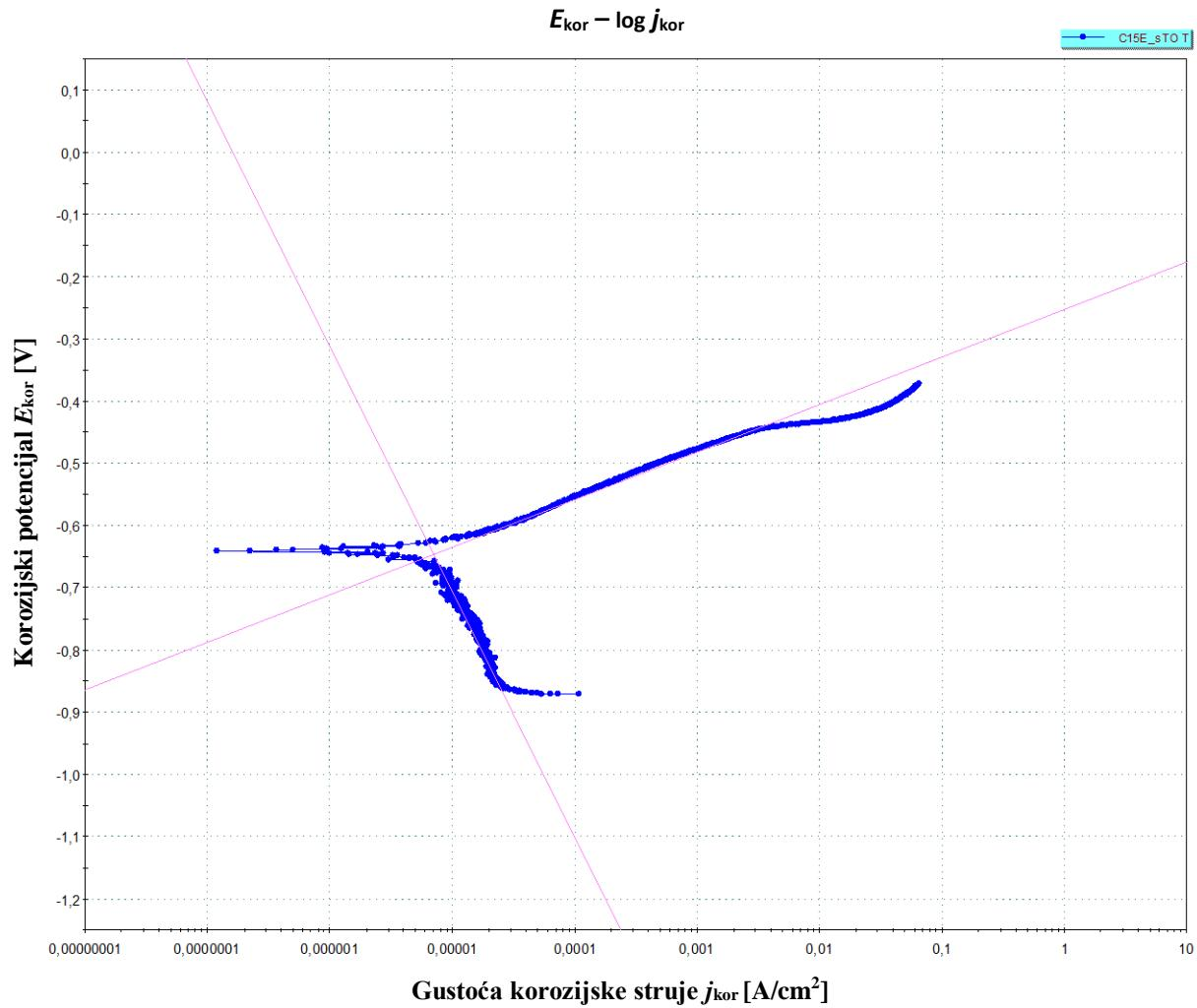
Slika 6.20. Ovisnost koroziskog potencijala o gustoći koroziskske struje – cementirani uzorak
