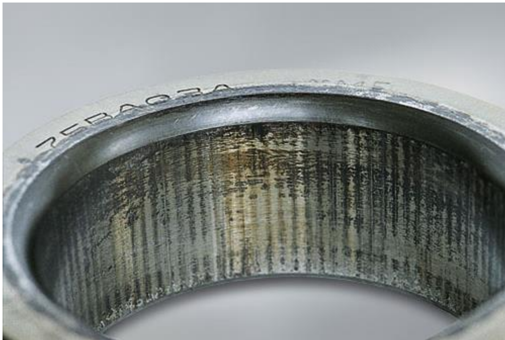
3.19. Tarna korozija unutarnjeg prstena kugličnog ležaja [40]
