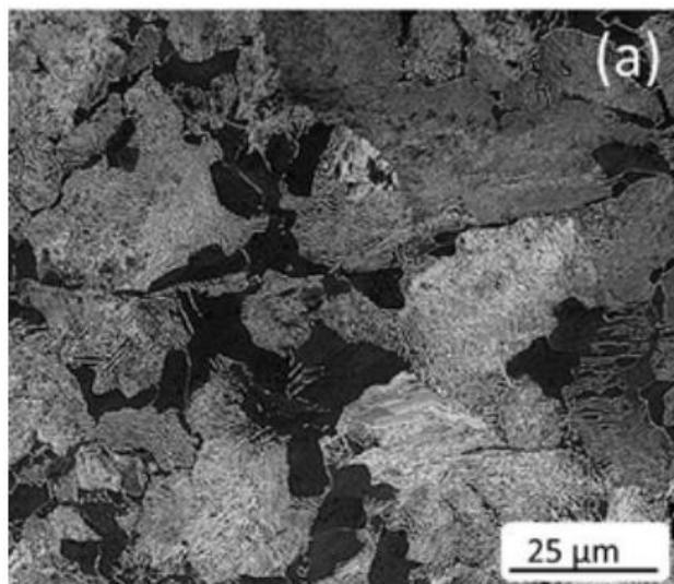
Slika 6.26. Feritno-perlitna mikrostruktura niskougljičnog čelika (svjetlija područja – ferit, tamnija područja - perlit) [56]
