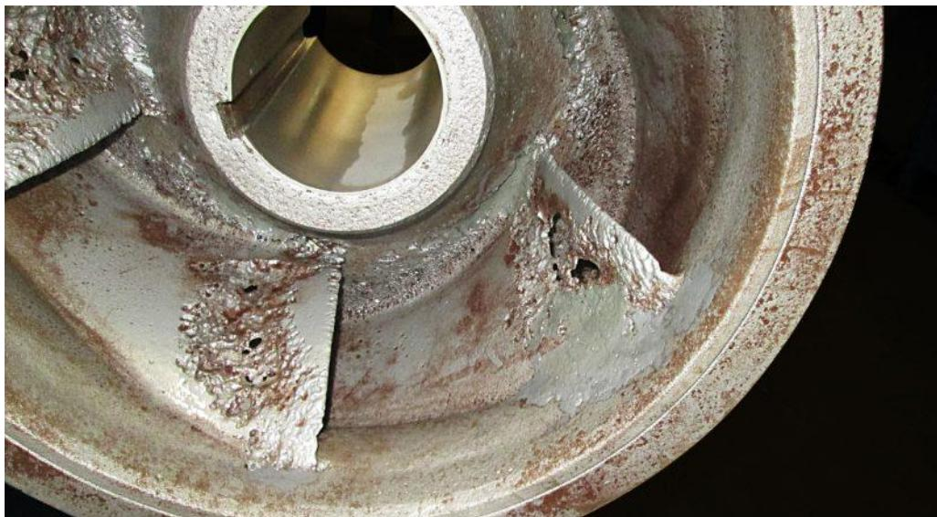
Slika 3.21. Kavitacijska korozija rotora crpke [42]
