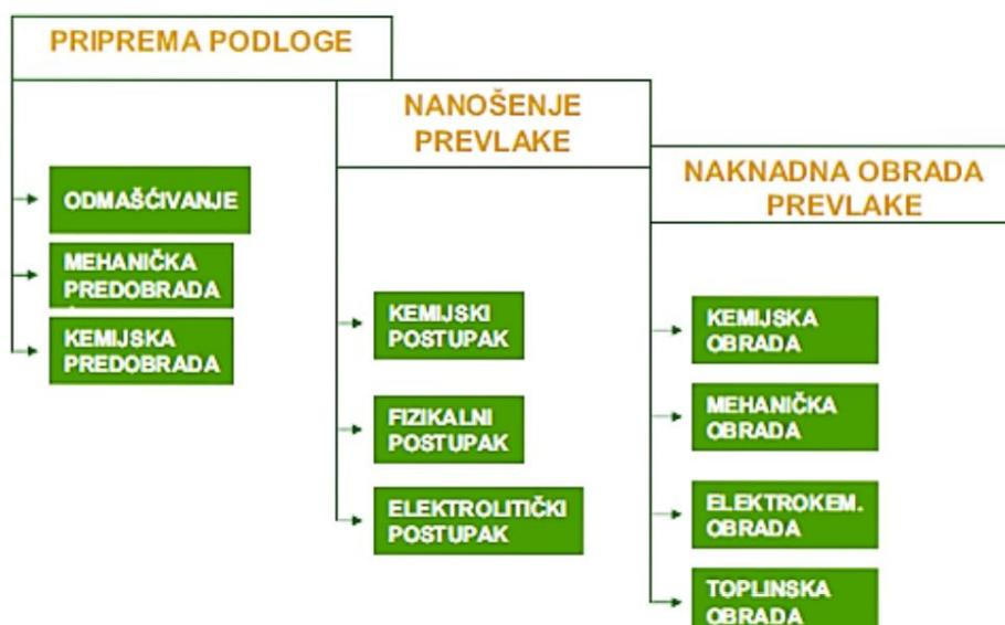
Slika 4.3. Aktivnosti pripreme podloge, nanošenja prevlake i naknadne obrade prevlake [18]
