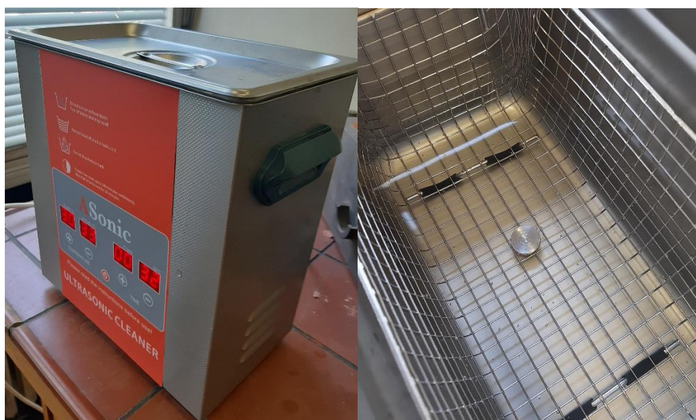
Slika 6.10. Čišćenje uzoraka u ultrazvučnoj kupelji „ASonic PRO 30“
