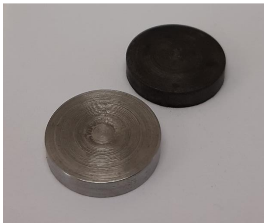
Slika 6.1. Ispitni uzorci prije i nakon toplinske obrade
