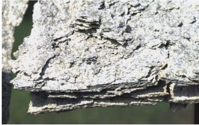
Slika 3.7. Eksfolijacija (raslojavanje, listanje) aluminijske legure u morskoj sredini [27]
