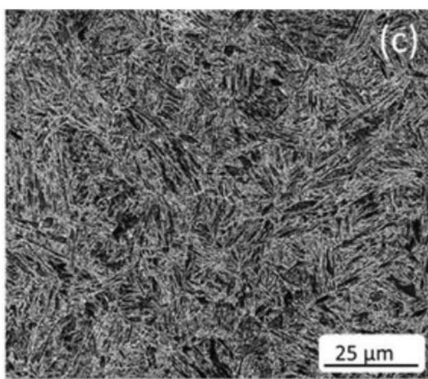
Slika 6.27. Martenzitna mikrostruktura niskougljičnog čelika ostvarena cementiranjem [56]
