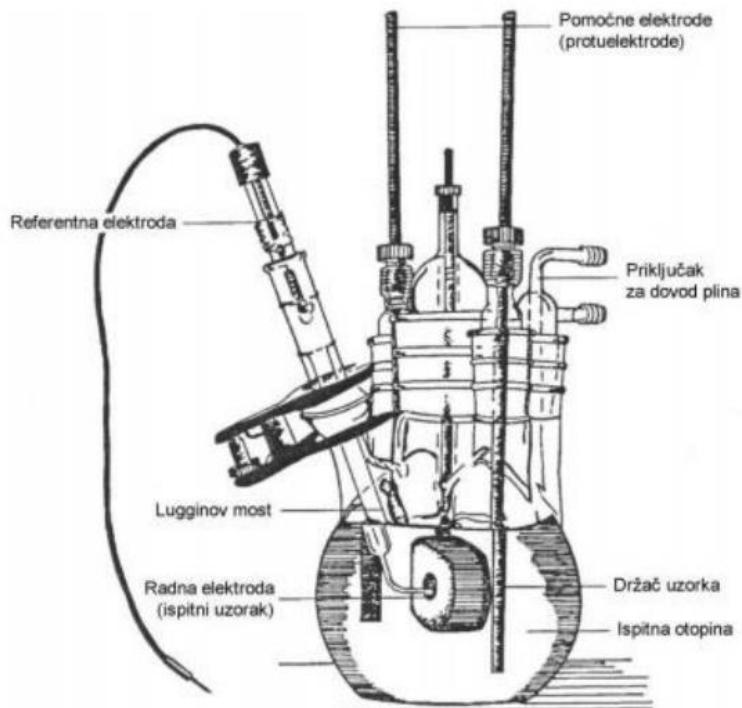
Slika 2.11. Primjer čelije za elektrokemijska ispitivanja [18]
