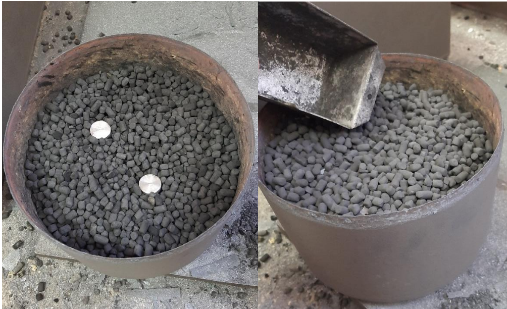
Slika 6.2. Ispitni uzorci položeni u granulat (lijevo) te prekriveni granulatom (desno)
