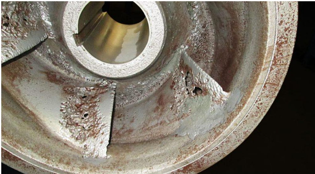
Slika 3.21. Kavitacijska korozija rotora crpke [42]
