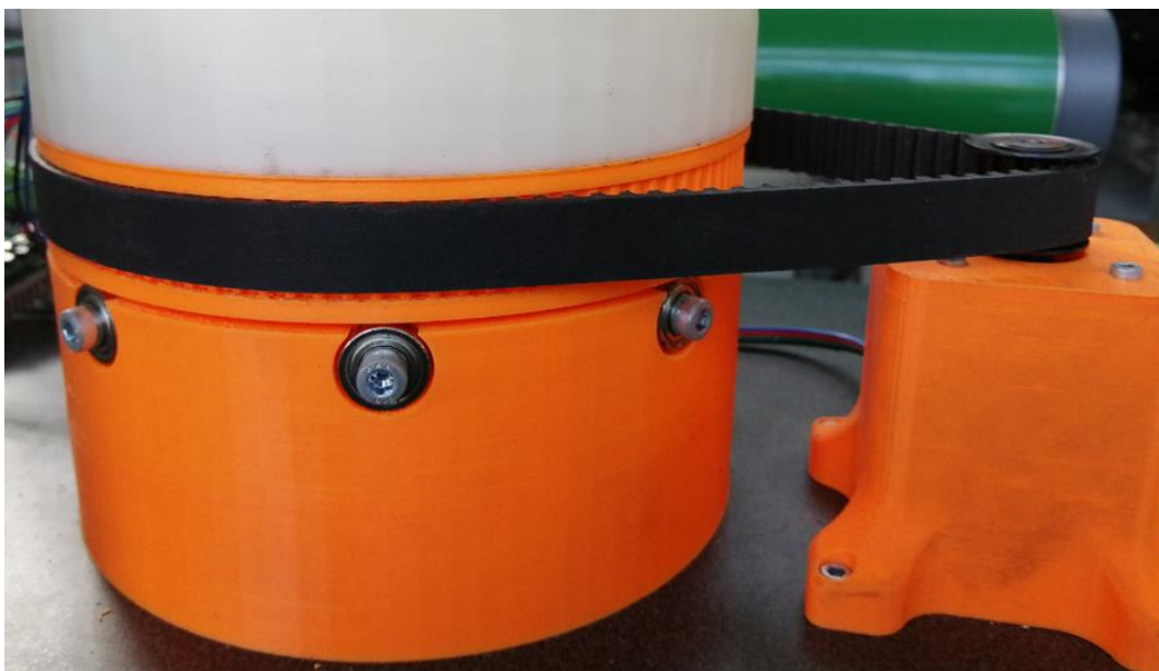
Slika 3.6. Prijenos okretnog momenta zupčastim remenom
