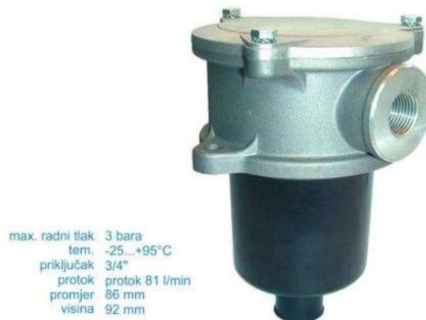
Slika 2-8 Filter ulja
