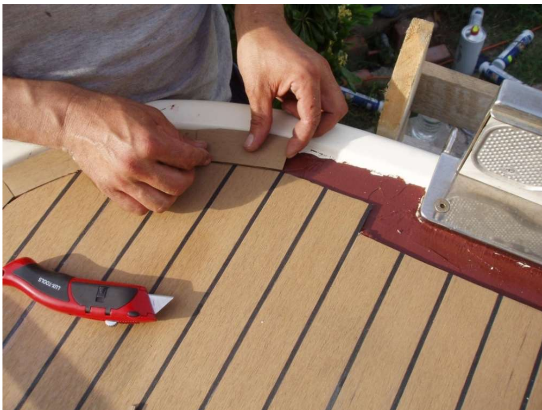
Slika 3.22 Paluba sa tikovim gređicama, [10]
